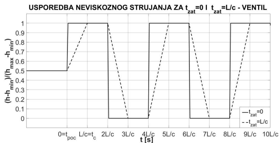
Slika 58 – Usporedba promjene piezometričke visine na mjestu ventila za vrijeme zatvaranja ventila t_{zat} = 0 i t_{zat} = L/c pri neviskoznom strujanju fluida
