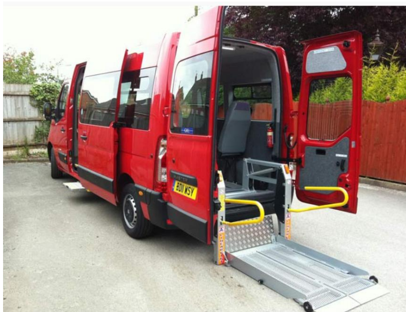
Slika 2. Minibus prerađen za prijevoz osoba s invaliditetom [4]
