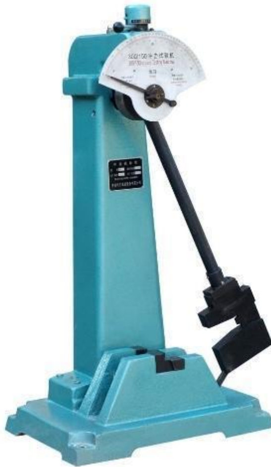
Slika 4.7 Charpy-ev bat, uređaj za ispitivanje žilavosti, [22]
