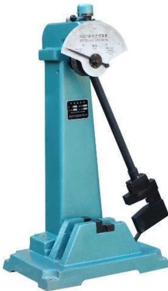
Slika 4.7 Charpy-ev bat, uređaj za ispitivanje žilavosti, [22]
