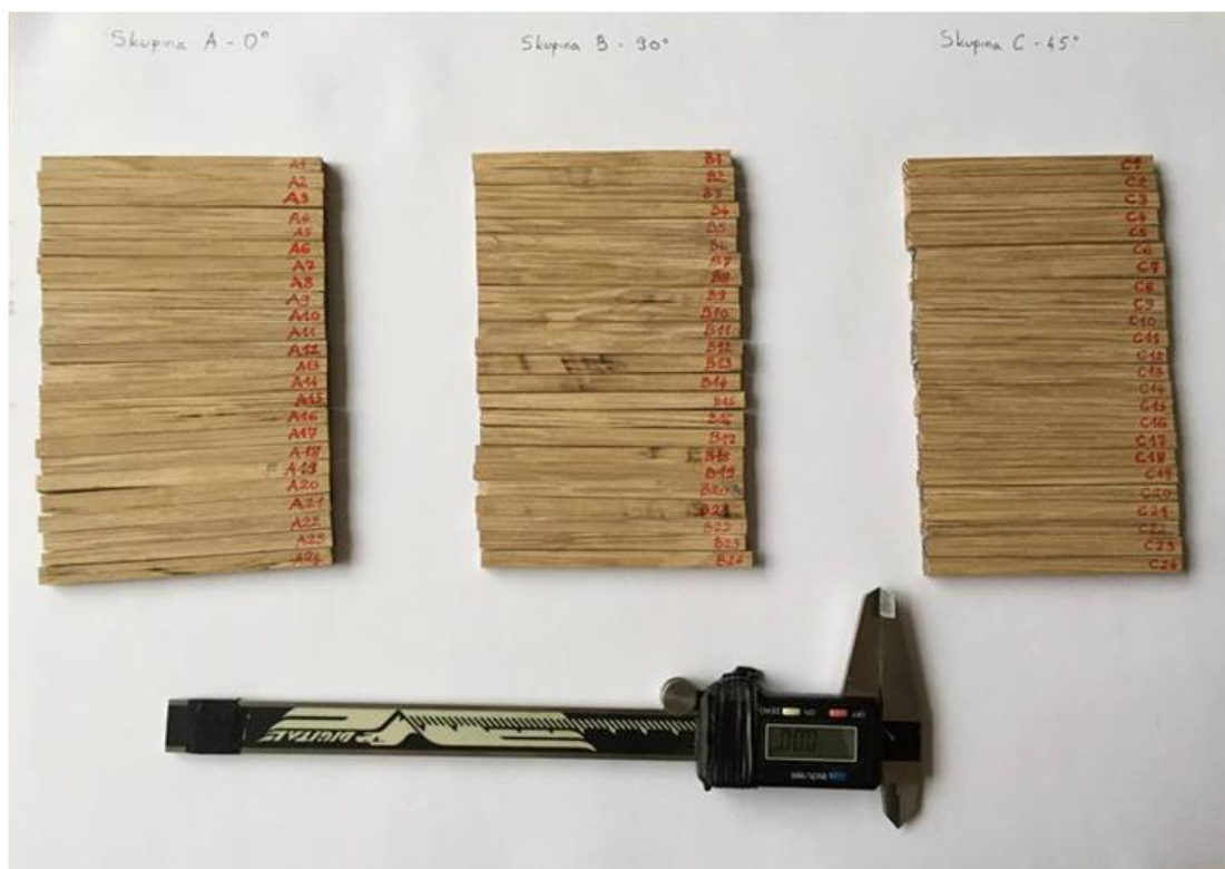
Slika 6.6 Oznaka i mjerenje dimenzija epruveta
