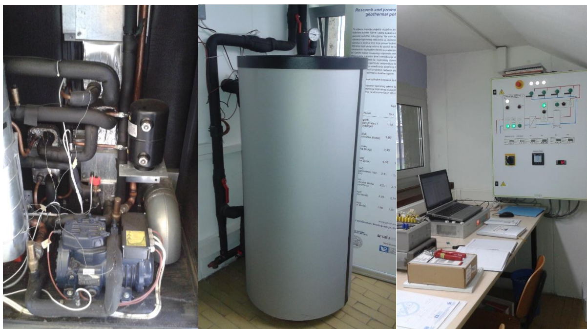
Slika 7, Dizalica topline, spremnik ogrjevnje vode, sustav za praćenje parametara
