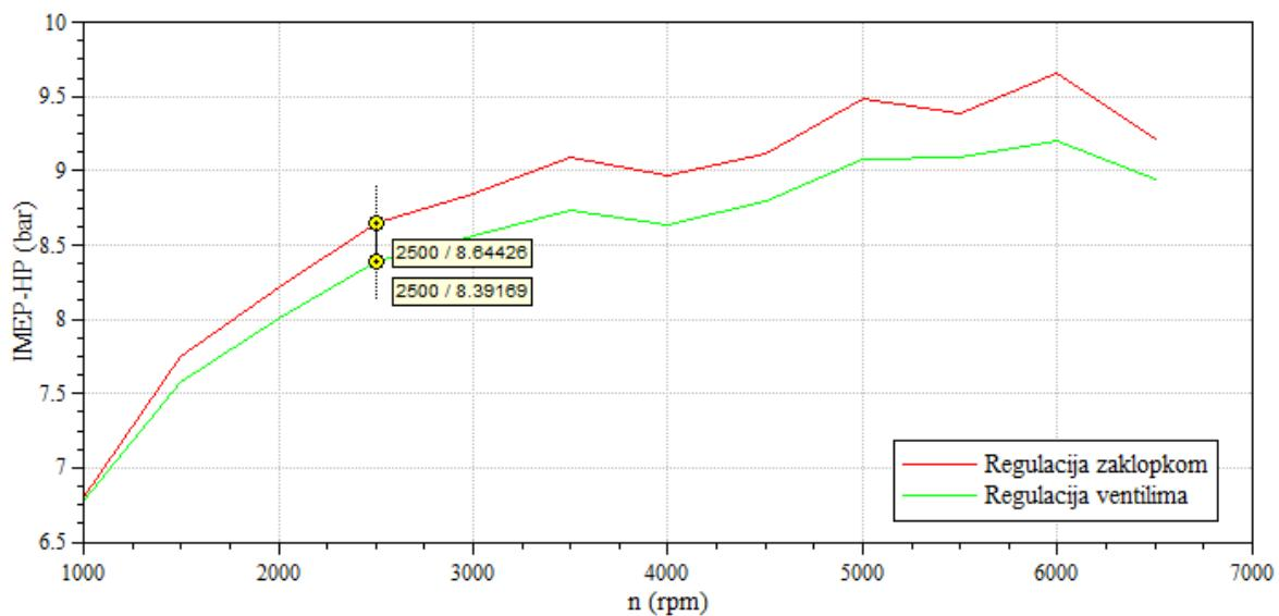
**Slika 30.** Srednji indicirani tlak za 60% opterećenja, visokotlačni dio
