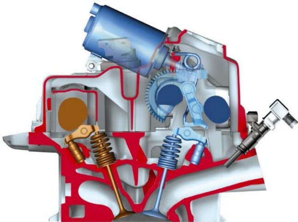
**Slika 13. Motor s ugrađenim sustavom Valvetronic [13]**
