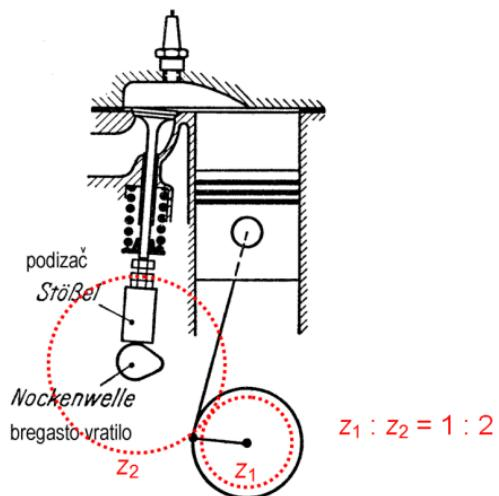
**Slika 1. Prijenosni omjer radilice i bregaste osovine [1]**
