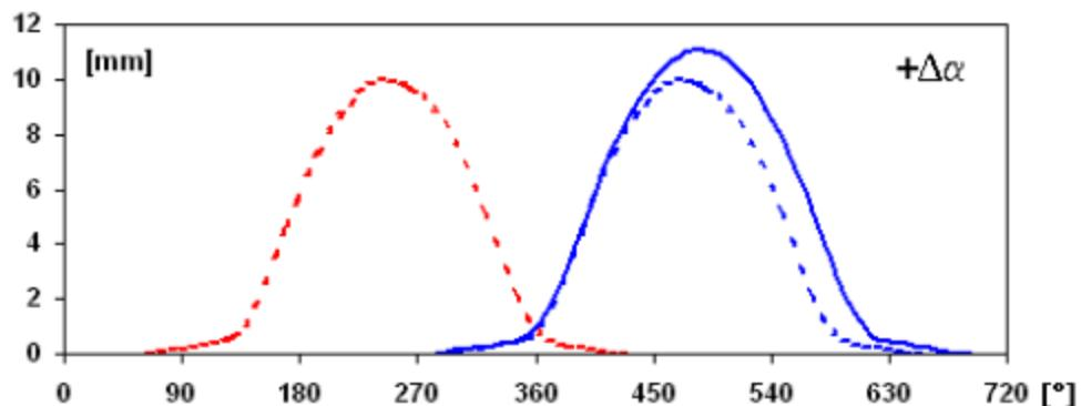
**Slika 12. Pomak točke UZ u desno produljuje otvorenost usisnog ventila**
