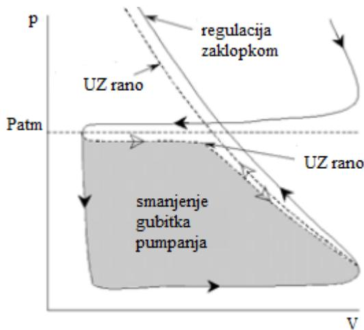
**Slika 17. Rano zatvaranje usisnog ventila [16]**
