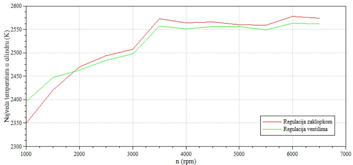
Slika 39: Najveća temperatura u cilindru pri 80% opterećenju
