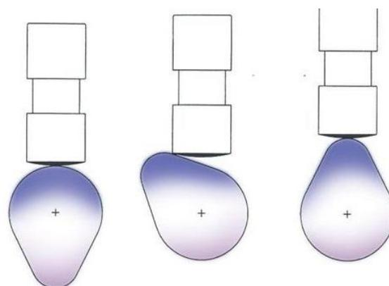
**Slika 6. Princip otvaranja i zatvaranja ventila [5]**
