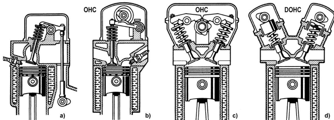
**Slika 2. Viseći ventili: a) bregasto vratilo u bloku; b), c) i d) bregasto vratilo u glavi [1]**
