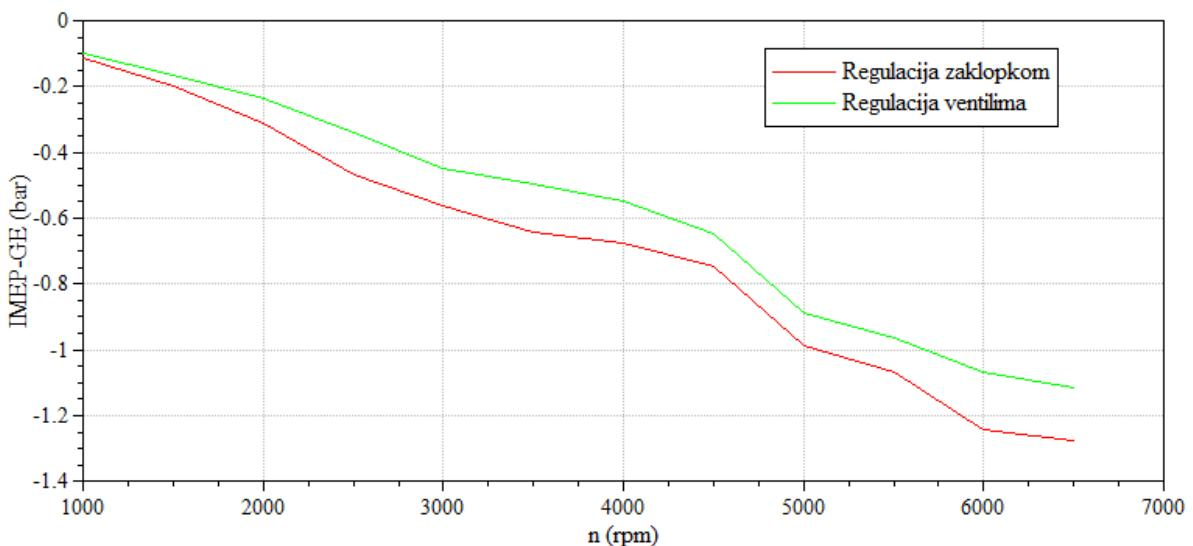
Slika 33. Srednji indicirani tlak za 80% opterećenja, niskotlačni dio
