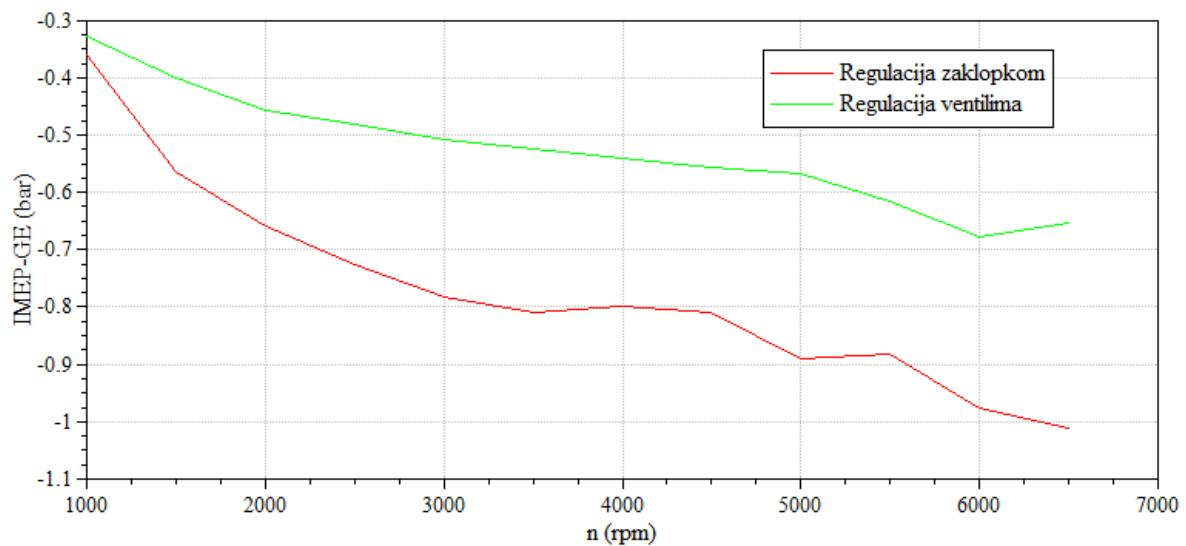
Slika 32. Srednji indicirani tlak za 20% opterećenja, niskotlačni dio
