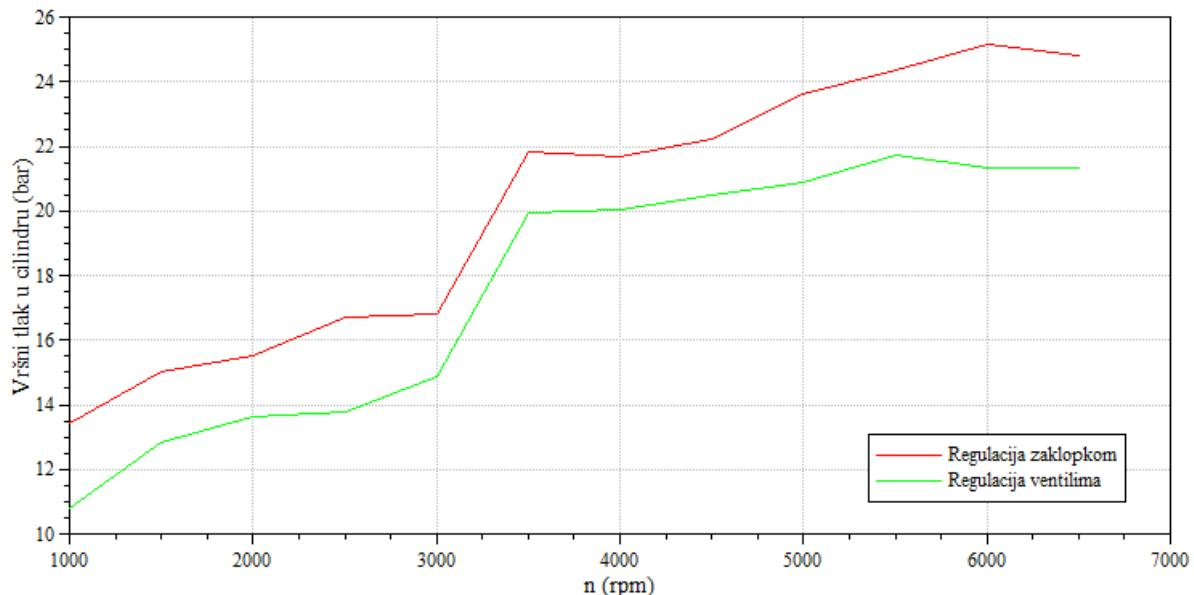
Slika 36: Vršni tlak u cilindru pri 20% opterećenja
