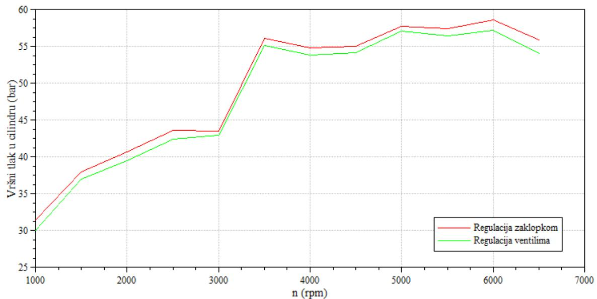
Slika 37: Vršni tlak u cilindru pri 80% opterećenja
