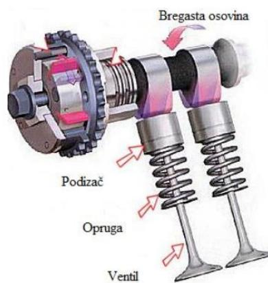
**Slika 3. Izvedba razvodnog mehanizma s gornjim razvodom [2]**
