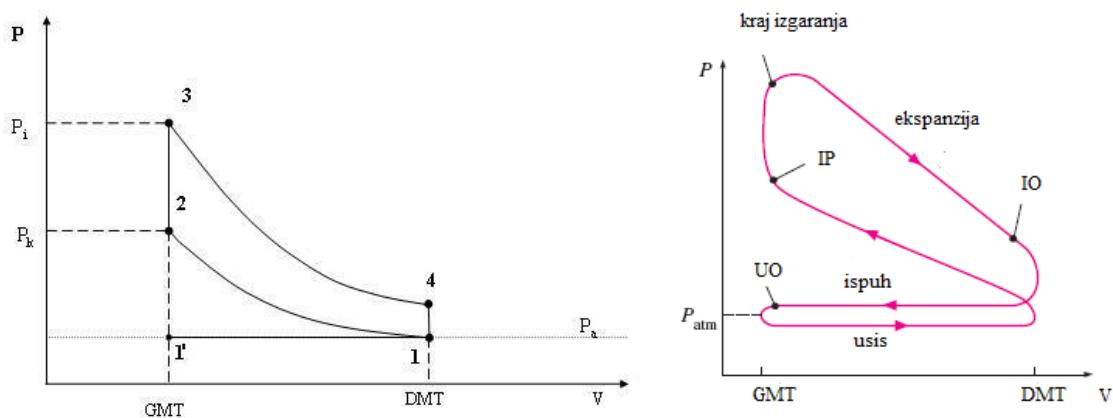
Slika 16. p.V dijagram idealnog (lijevo) i realnog Otto procesa (desno) [14, 15]
