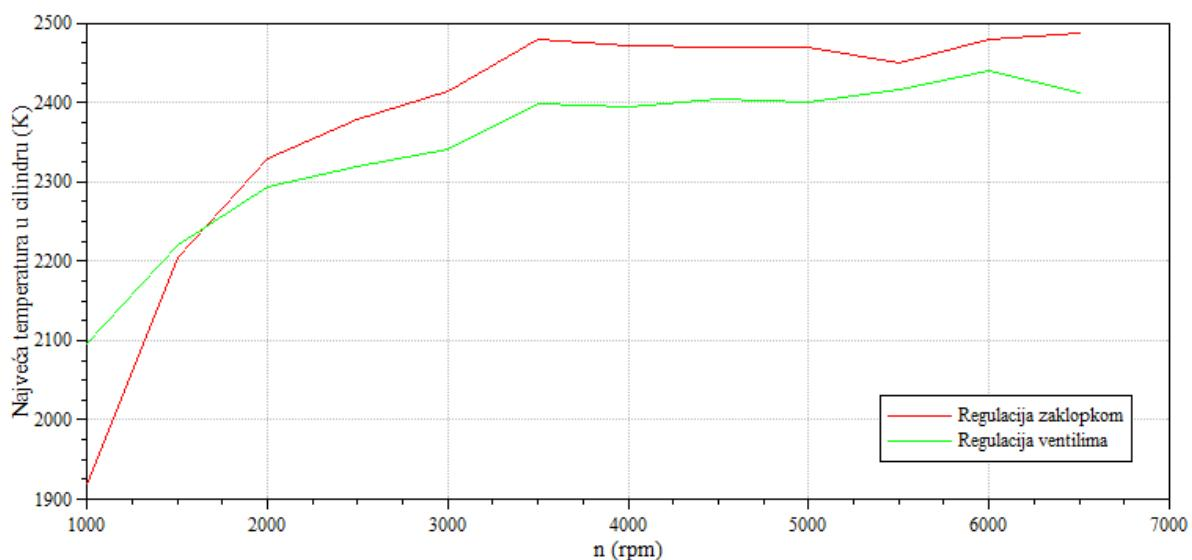
Slika 38: Najveća temperatura u cilindru pri 20% opterećenja
