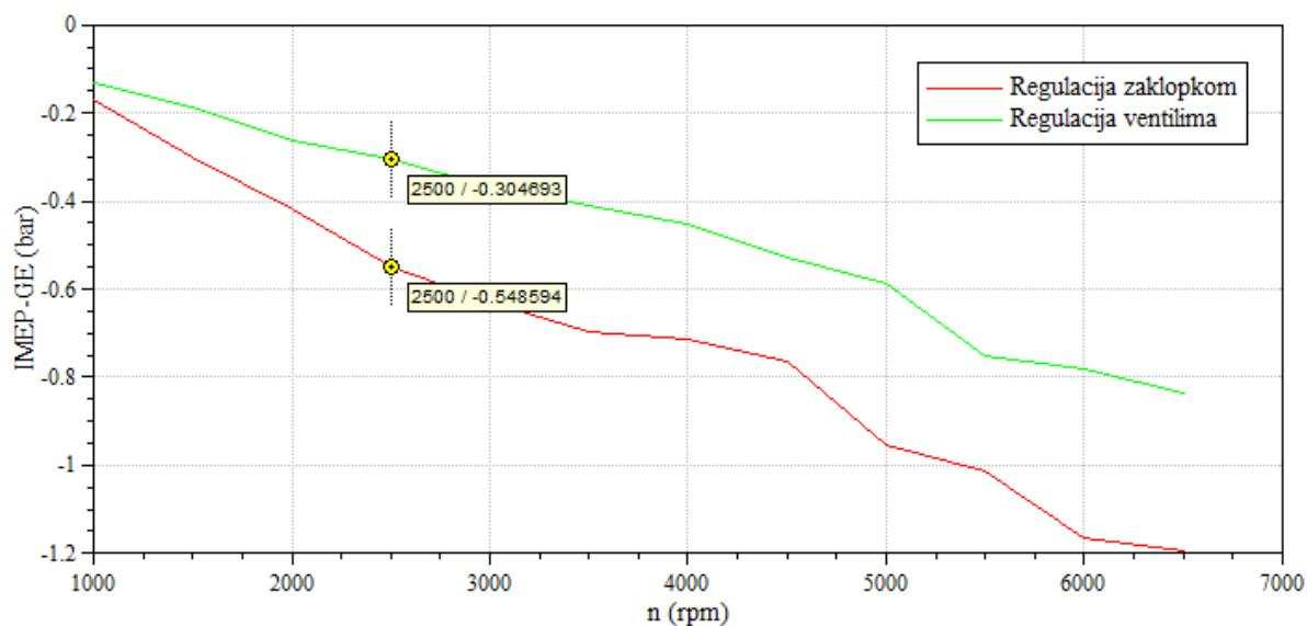
**Slika 29. Srednji indicirani tlak za 60% opterećenja, niskotlačni dio**
