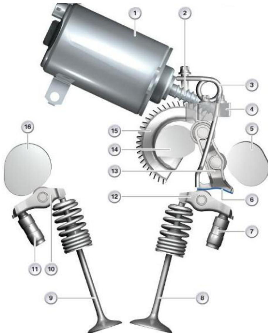
**Slika 14. Dijelovi sustava Valvetronic [13]**
