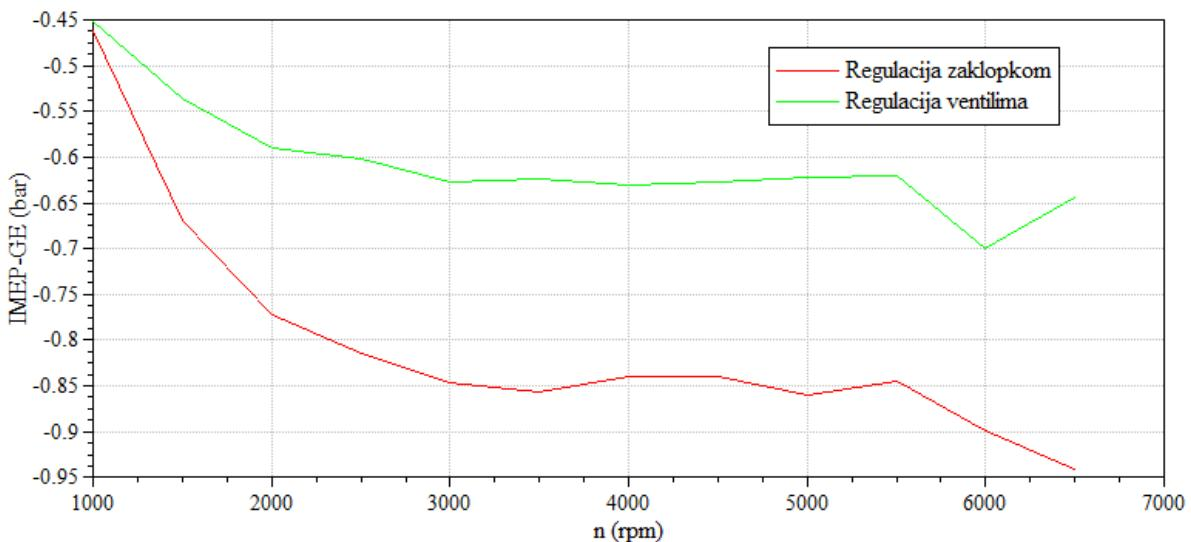
**Slika 31.** Srednji indicirani tlak za 5% opterećenja, niskotlačni dio
