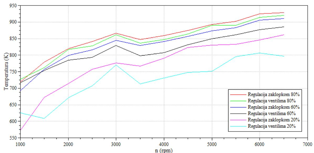
Slika 40: Temperature ispuha za 20%, 60% i 80% opterećenja
