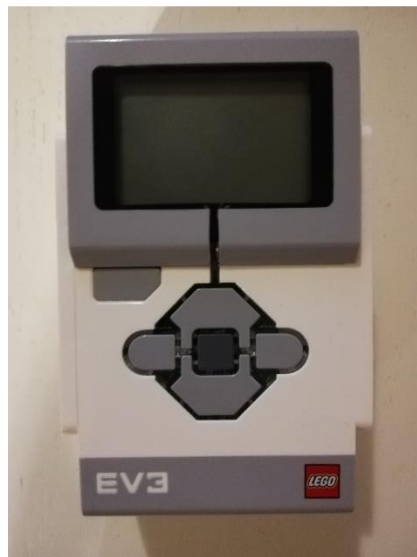
Slika 21. Lego EV3 Brick upravljačka jedinica
