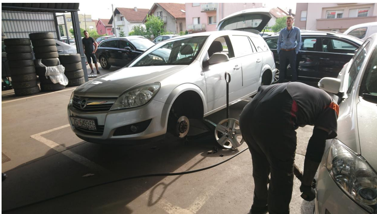
Slika 12. Način podizanja vozila postojećom opremom (podizanje samo jedne strane vozila
