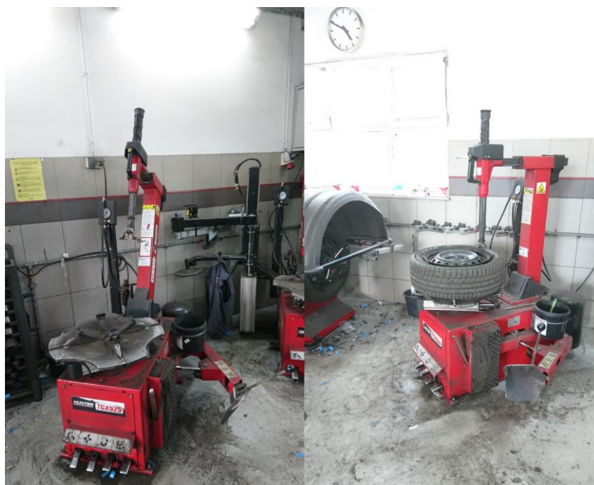
Slika 4. Stroj za montažu i demontažu gume s naplatka “Hunter TCX525“
