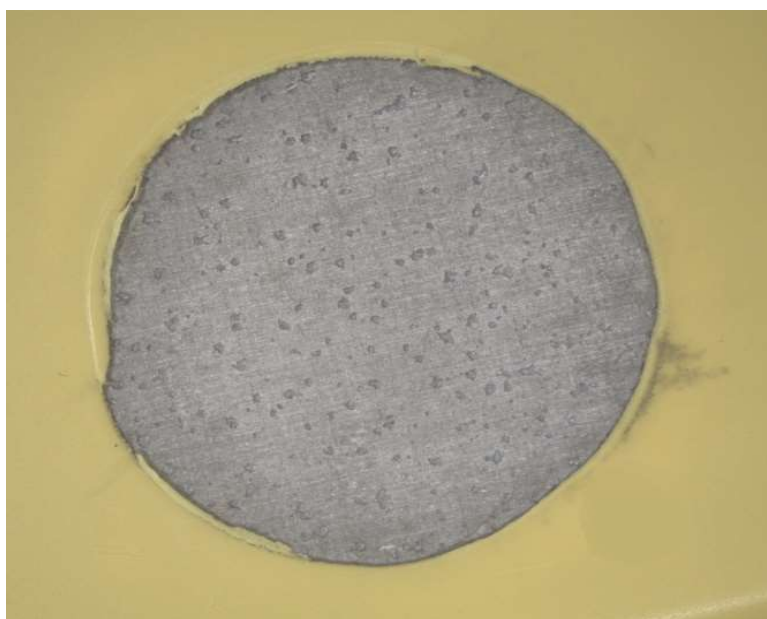
Slika 56. Površina uzorka poslije Tafelove ekstrapolacije; vidljiva rupičasta korozivna oštećenja
