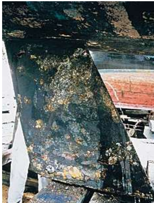
Slika 8. Rupičasta (eng. pitting ) korozija na kobilici broda [9]
