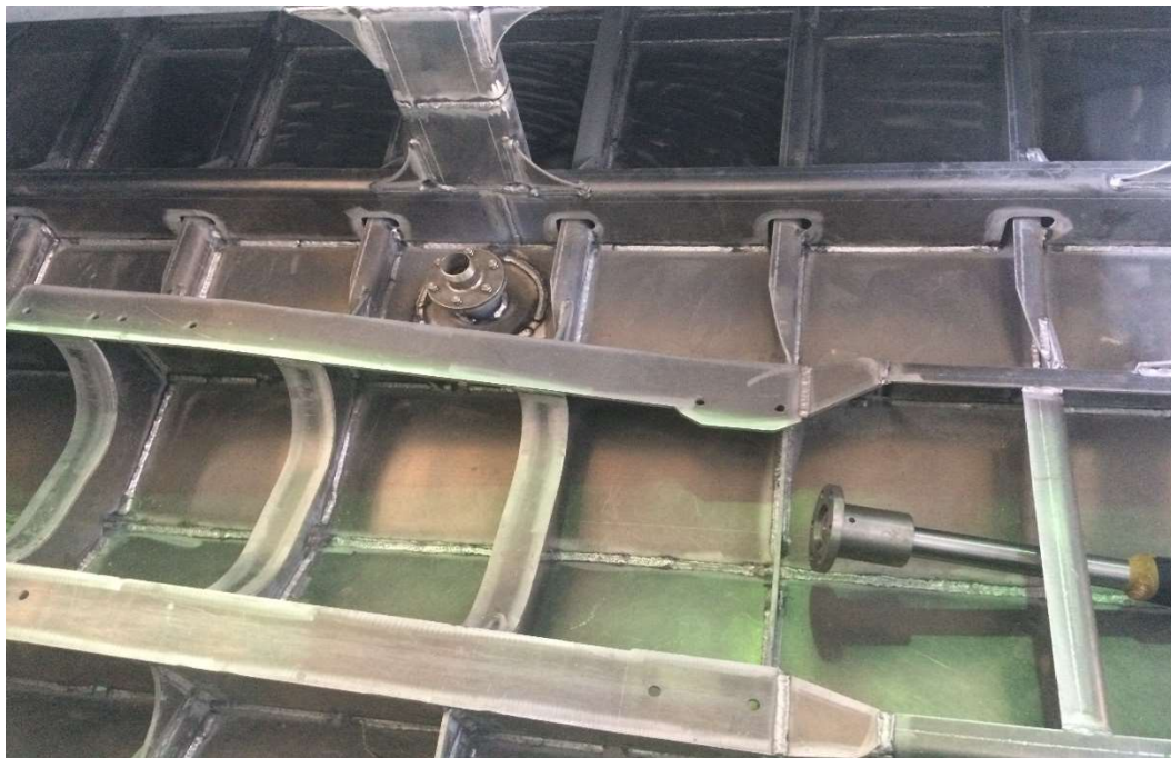
Slika 31. Nosači dna broda
