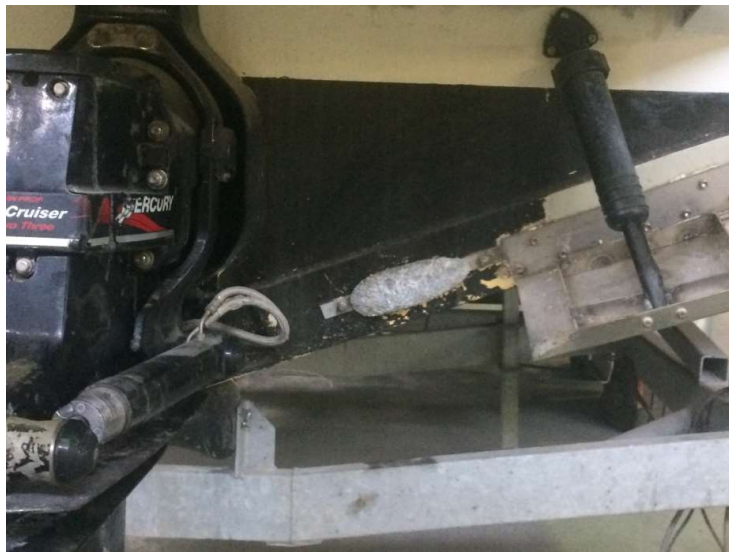
Slika 30. Istrošena cinkova anoda
