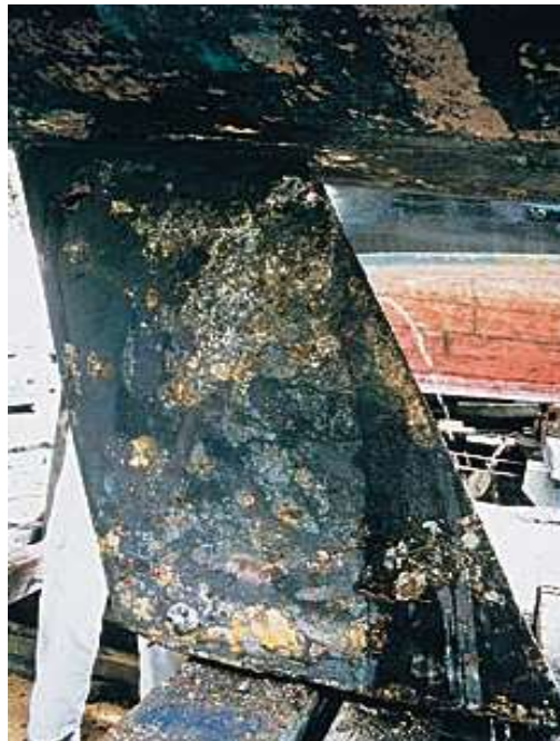
Slika 8. Rupičasta (eng. pitting ) korozija na kobilici broda [9]
