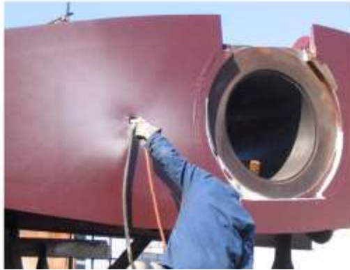
Slika 17. Zaštita unutrašnjosti lista kormila [6]
