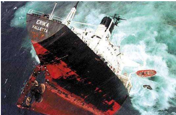
Slika 3. Brodolom zbog korozijskog oštećenja – Tanker Erika [5]
