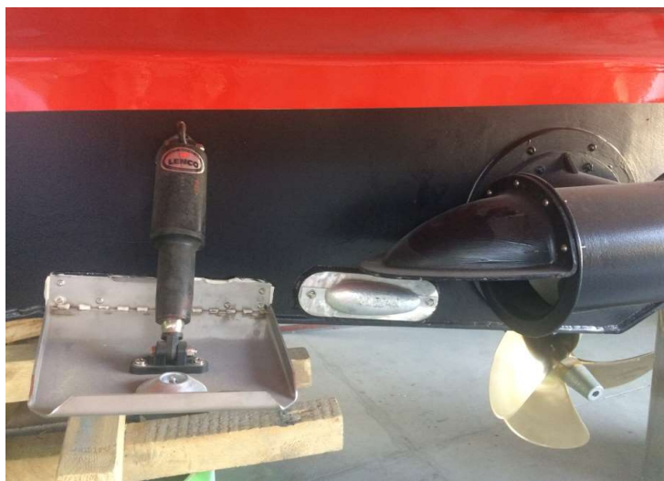
Slika 29. Nova cinkova anoda
