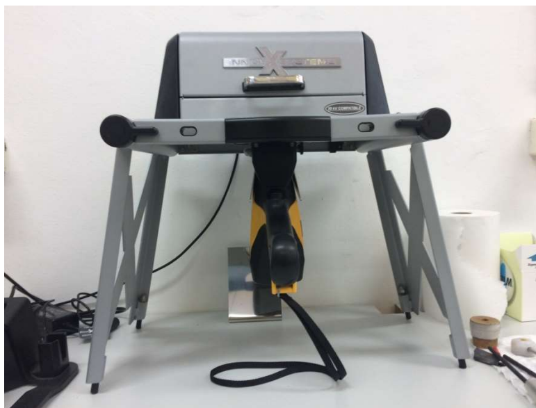
Slika 41. XRF uređaj za utvrđivanje kemijskog sastava materijala
