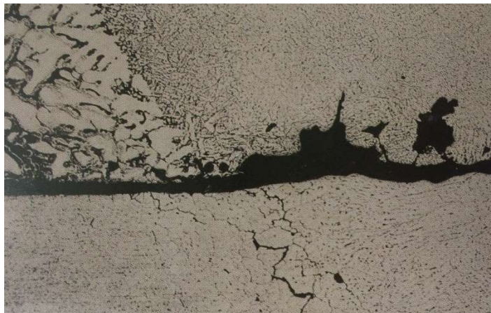
Slika 9. Interkristalna korozijana cjevovodu od aluminijske legure AA – 5083 [7]
