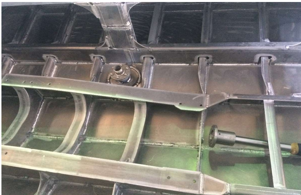
Slika 31. Nosači dna broda
