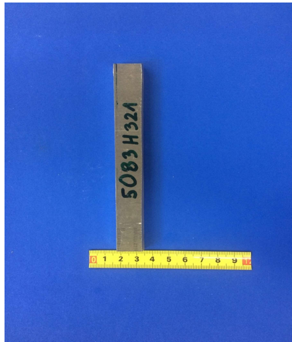
Slika 38. Odabrana aluminijska pločica (AA – 5083 H321)
