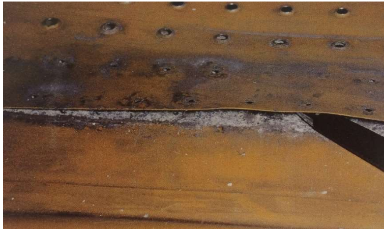
Slika 21. Korozija u procijepu aluminijske legure nakon 11 godina u službi u morskom okolišu [7]
