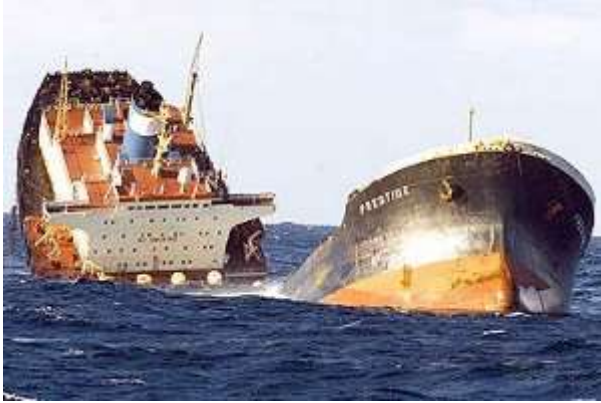
Slika 2. Brodolom zbog korozijskog oštećenja – Tanker Prestige [5]
