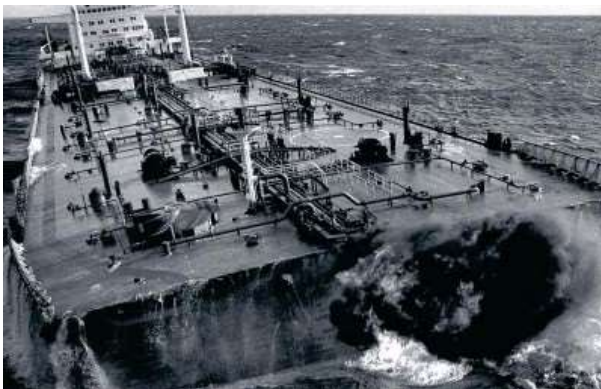
Slika 4. Brodolom zbog korozijskog oštećenja – Tanker Kirki [5]
