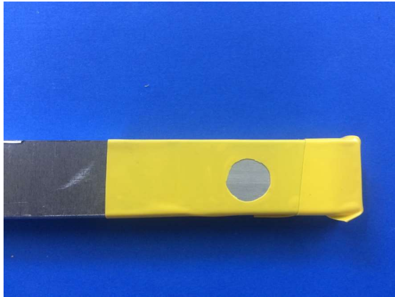
Slika 39. Površina koja će biti ispitivana na koroziju
