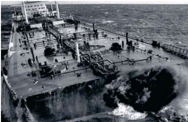
Slika 4. Brodolom zbog korozijskog oštećenja – Tanker Kirki [5]
