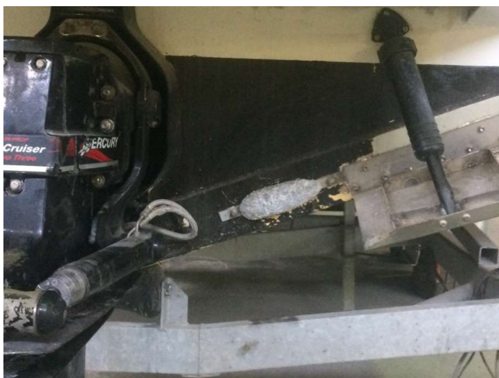
Slika 30. Istrošena cinkova anoda
