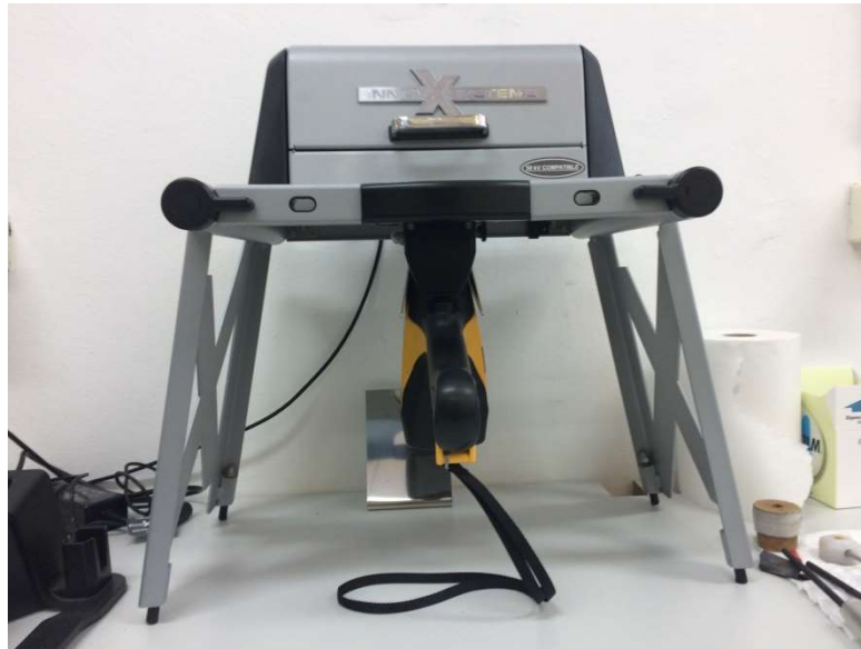
Slika 41. XRF uređaj za utvrđivanje kemijskog sastava materijala
