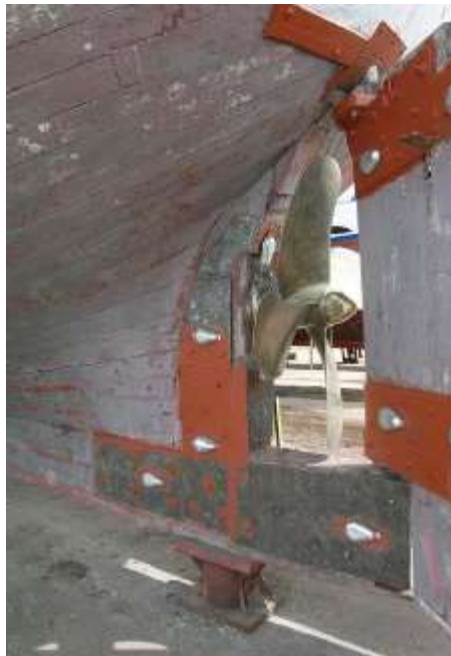
Slika 16. Katodna zaštita metalnih dijelova na drvenom brodu [5]
