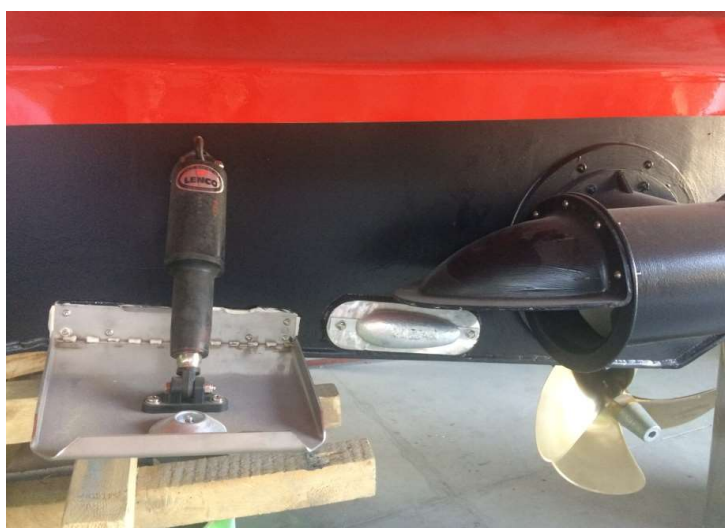
Slika 29. Nova cinkova anoda
