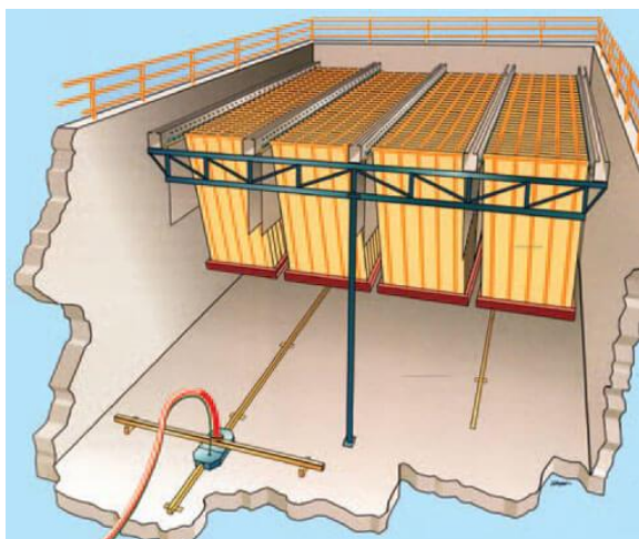
Slika 21. Montažna skica Ovivo FlexKlear taložnika
