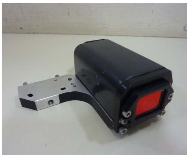
Slika 11 PS-kamera modela Fanuc A05B-1405-H036
