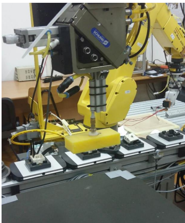
Slika 24 Prijenos prvog predmeta prema paleti
