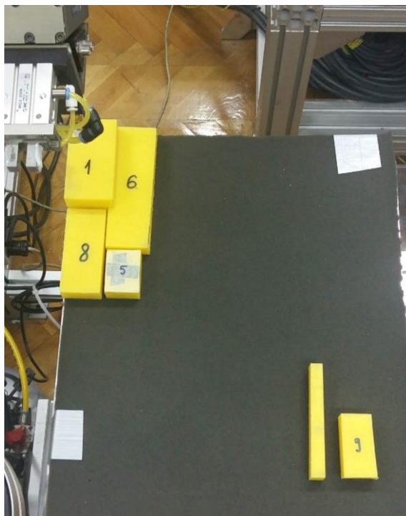
Slika 29 Prikaz paleta te dijagonalno postavljenog međuprostora
