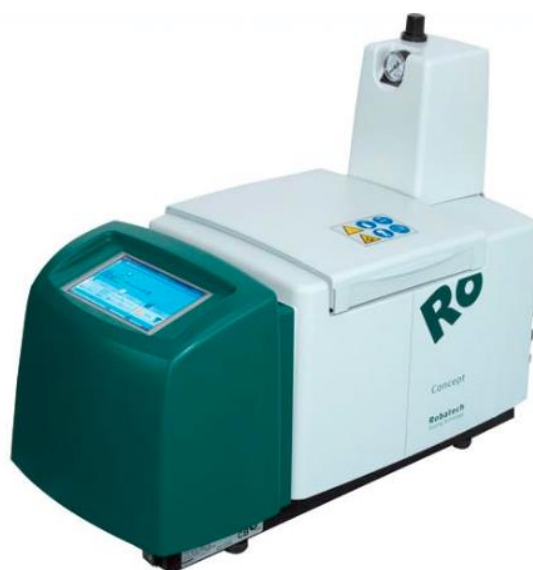
Slika 41. Concept stream – spremnik za ljepilo [29]
