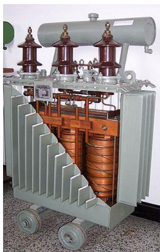
Slika 1. Trofazni distributivni transformator [2]
