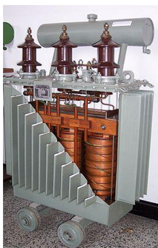
Slika 1. Trofazni distributivni transformator [2]
