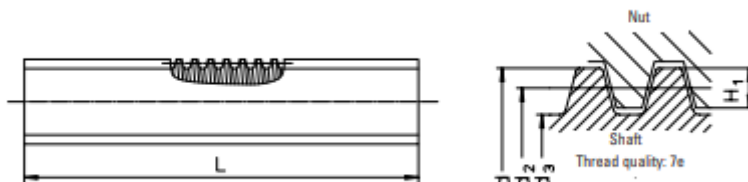
Tablica 10. Dimenzijske karakteristike odabranog trapeznog vretena [17]
