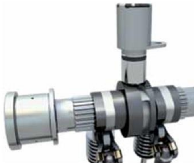
Slika 5. Trostupanjski sustav s pomičnim brijegom bregastog vratila [3]
