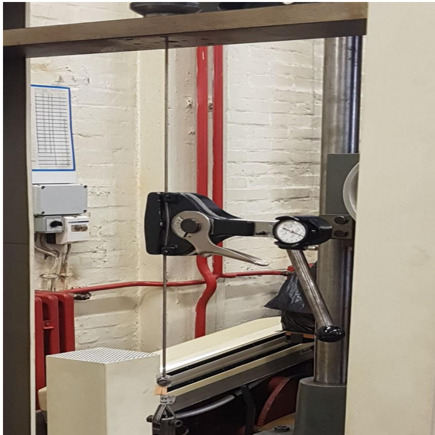
Slika 31. Postupak mjerenja tenzometrom
