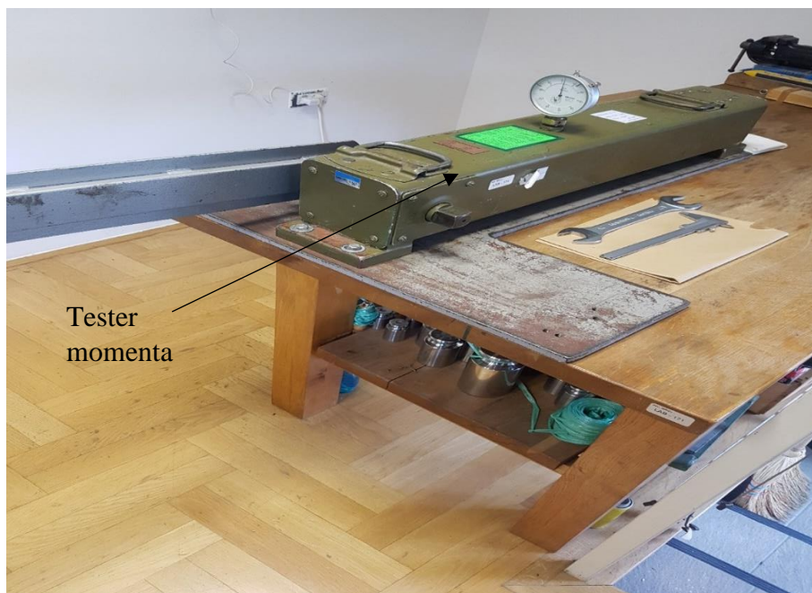
Slika 24. Tester momenta sile Drumwillow L
