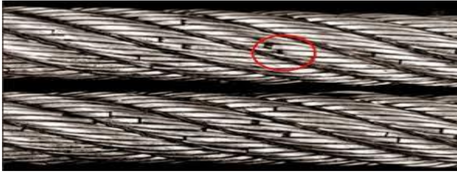
Slika 4. Savojni lom umora materijala užeta u spojnim nitima [5]
