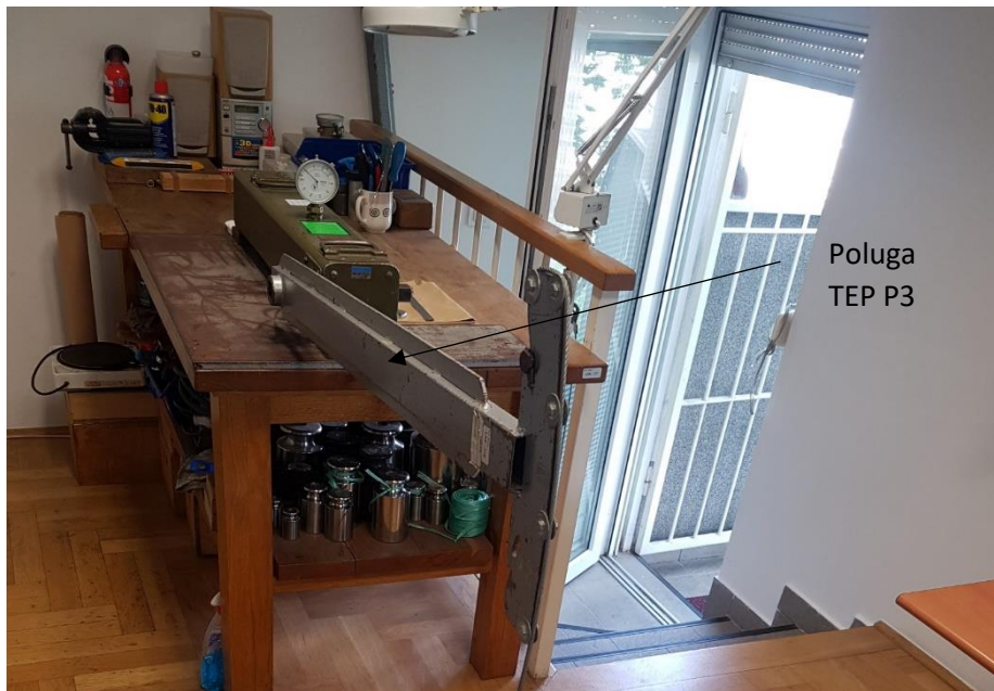
Slika 25. Poluga TEP P3 pričvršćena na tester
