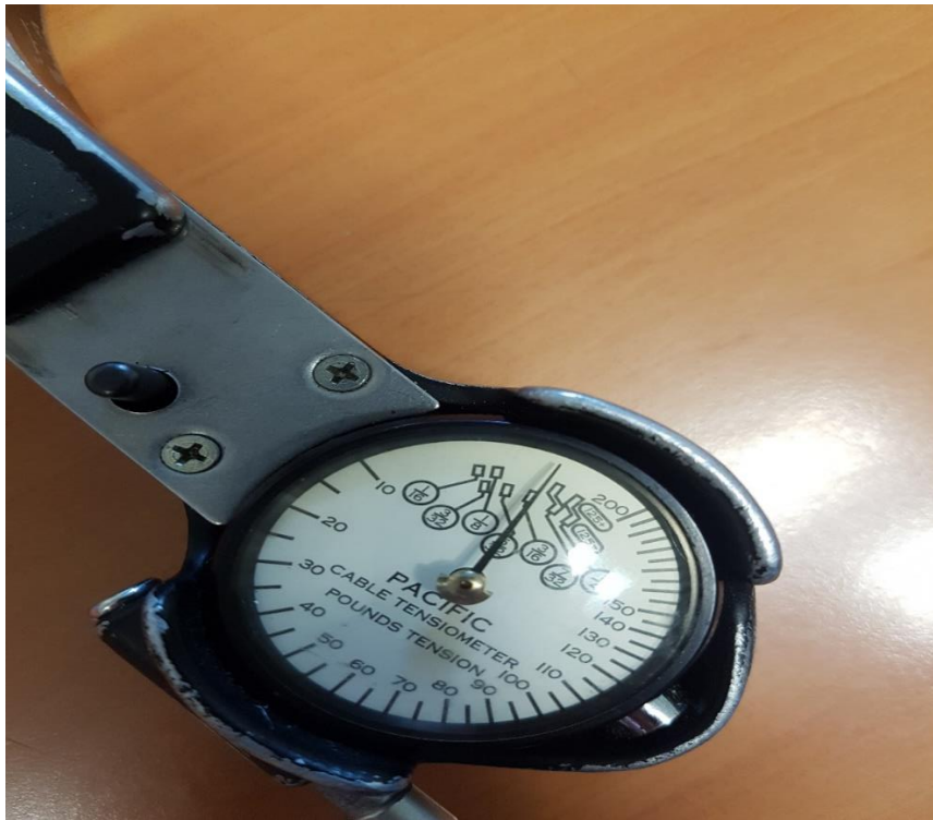
Slika 22. Mjerna skala tenzometra T60 tipa C8
