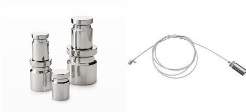
Slika 19. Mjerna oprema metode pomoću mjernih utega [15]
