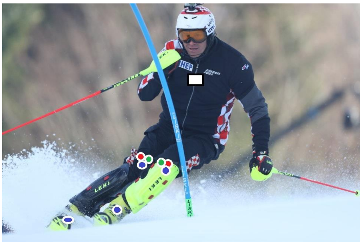
Slika 27. Položaji senzora u konceptualnom skijaškom mehatroničkom sustavu
