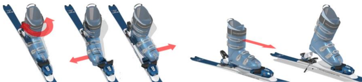
Slika 26. Mehanizam otpuštanja skijaških vezova [28]
