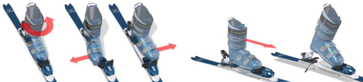
Slika 26. Mehanizam otpuštanja skijaških vezova [28]
