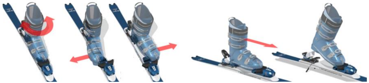
Slika 26. Mehanizam otpuštanja skijaških vezova [28]
