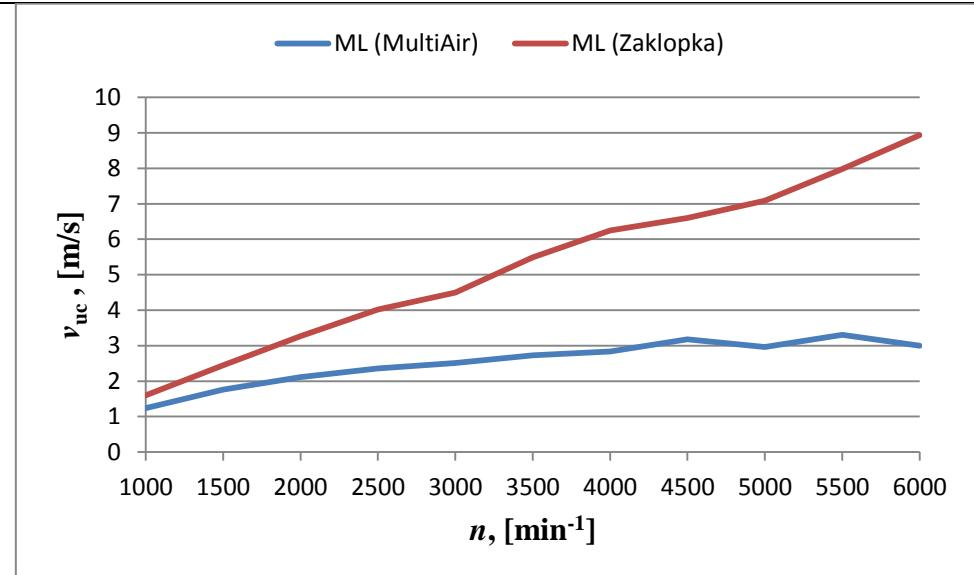
Slika 48. Brzina u usisnoj cijevi (mjerna točka MP2) za slučaj opterećenja ML
