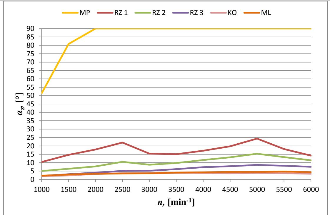
Slika 21. Kut otvorenosti zaklopke u modelu motora sa zaklopkom
