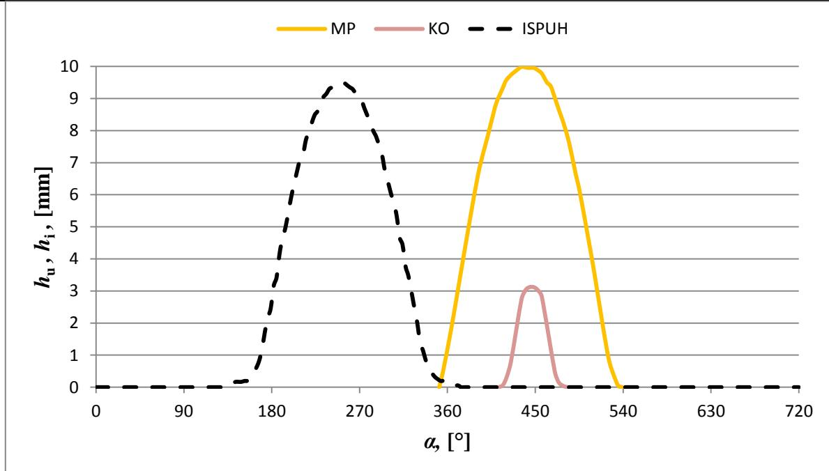
Slika 19. Profili otvaranja usisnih ventila kod kasnog otvaranja
