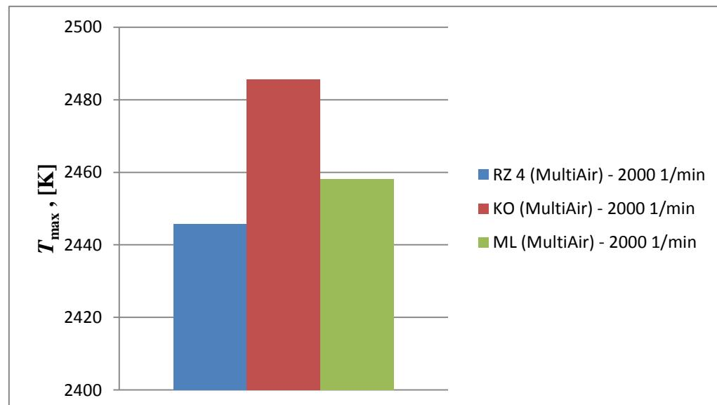
**Slika 57.** Maksimalna temperatura u cilindru za sve načine rada MultiAir sustava pri  $2000 \text{ min}^{-1}$
