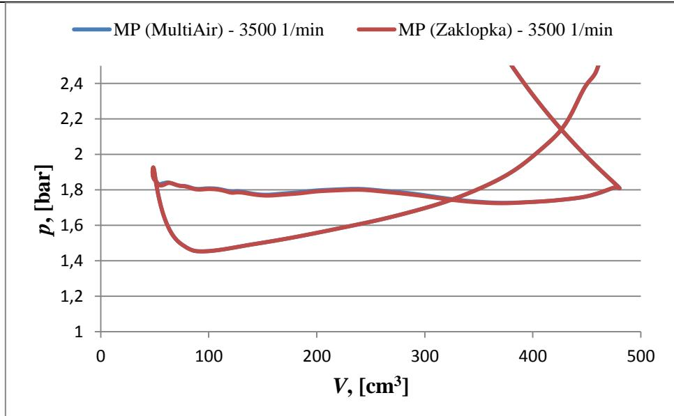
Slika 24. Niskotlačni dio  $pV$  dijagrama za opterećenje MP pri  $3500 \text{ min}^{-1}$
