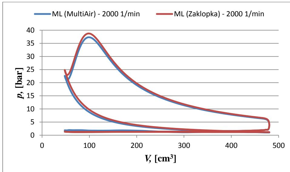
Slika 43.  $pV$  dijagram za opterećenje ML pri  $2000 \text{ min}^{-1}$
