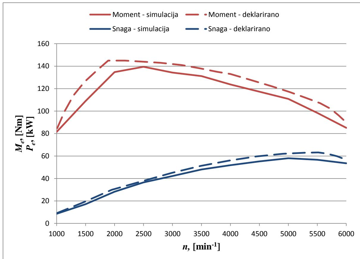
Slika 17. Usporedba momenta motora dobivenog simulacijom i deklariranog
