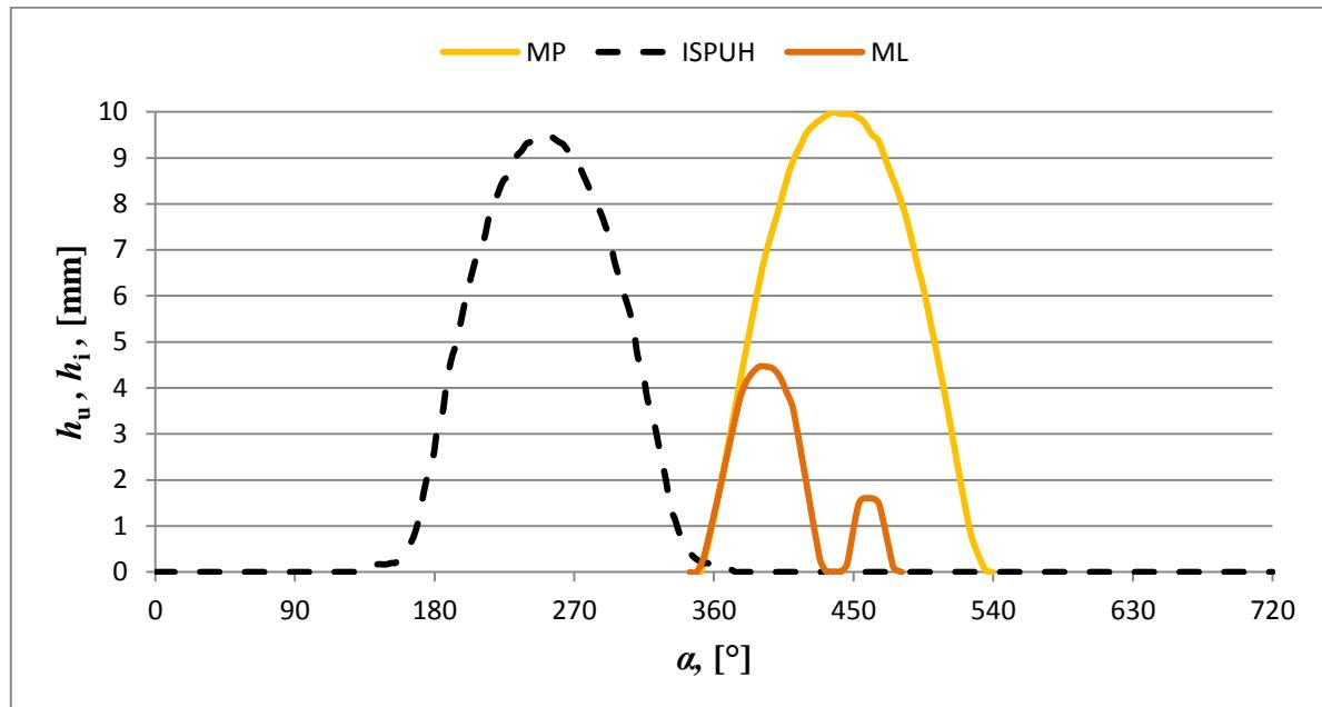
Slika 20. Profil otvaranja usisnih ventila u načinu rada Multilift
