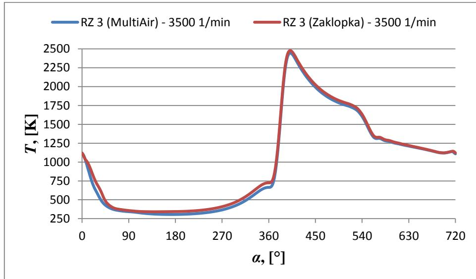
Slika 32. Temperatura u cilindru za opterećenje RZ 3 pri  $3500 \text{ min}^{-1}$
