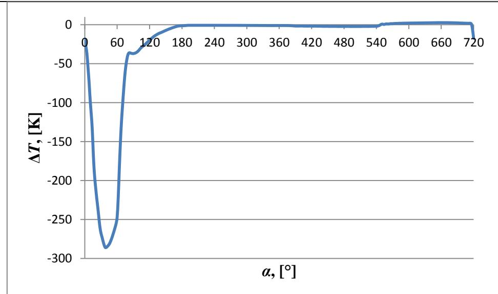
**Slika 39. Razlika u temperaturama u cilindru između modela sa MultiAirom i s zaklopkom za opterećenje KO pri 1500 min<sup>-1</sup>**
