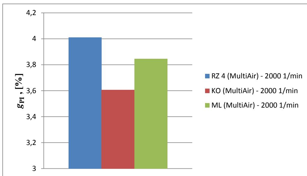
**Slika 56.** Udio zaostalih produkata izgaranja u cilindru u trenutku završetka taka usisa za sve načine rada MultiAir sustava pri  $2000 \text{ min}^{-1}$
