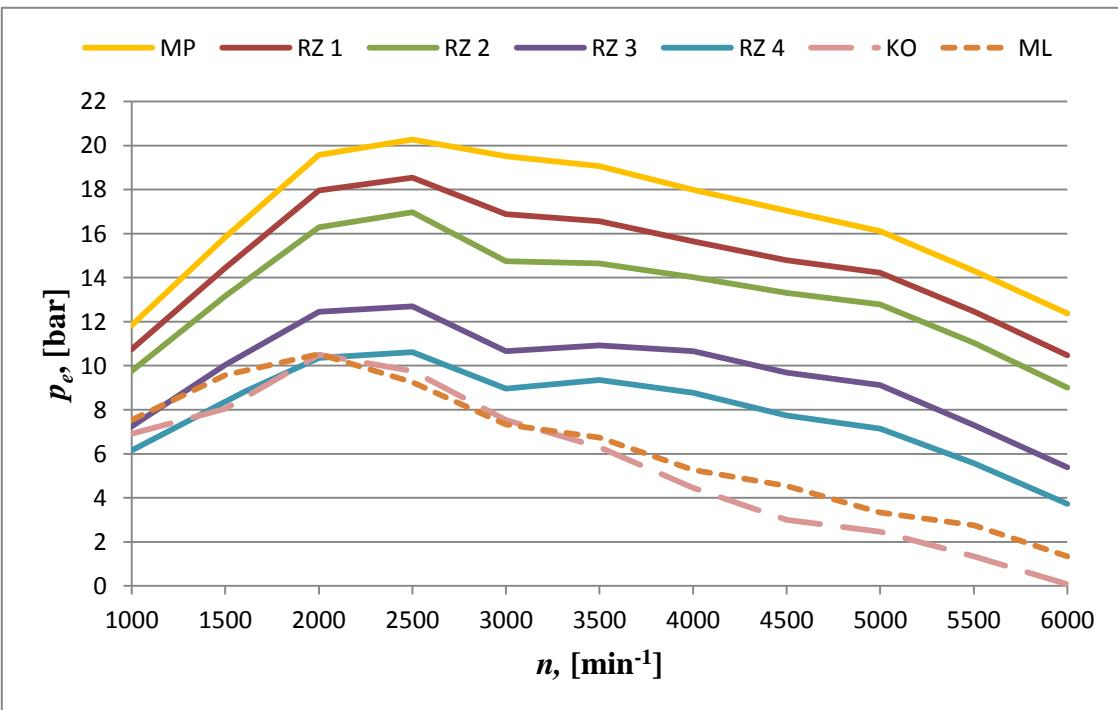
Slika 22. Srednji efektivni tlak u ovisnosti o brzini vrtnje kod razlicitih profila podizaja usisnih ventila
