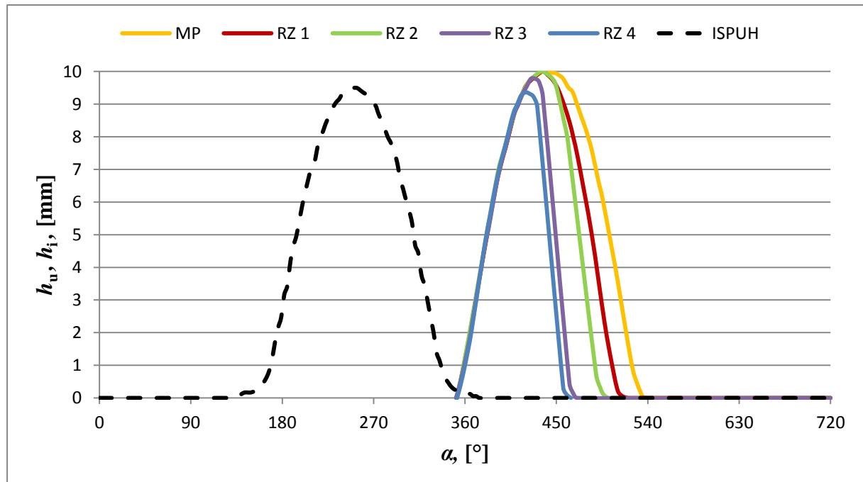
Slika 18. Profili otvaranja usisnih ventila kod ranog zatvaranja
