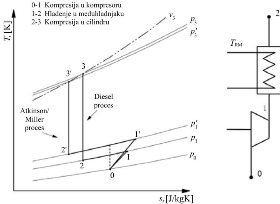
Slika 13. Usporedni  $Ts$  dijagram dijela Dieselovog procesa s Atkinsonovim te Millerovim [13]
