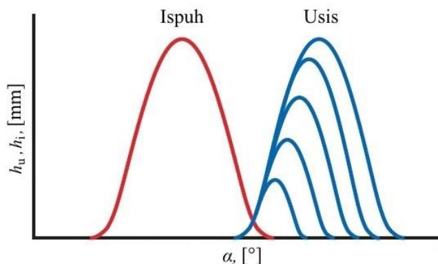
Slika 7. Rano zatvaranje usisnih ventila [2]
