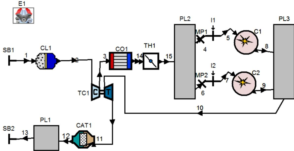
Slika 16. Simulacijski model odabranog motora sa zaklopkom
