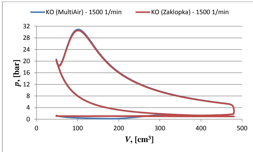
Slika 36.  $pV$  dijagram za opterećenje KO pri  $1500 \text{ min}^{-1}$
