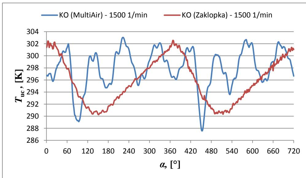
**Slika 40. Temperatura u usisnoj cijevi (mjerna točka MP2) za slučaj opterećenja KO pri 1500 min<sup>-1</sup>**
