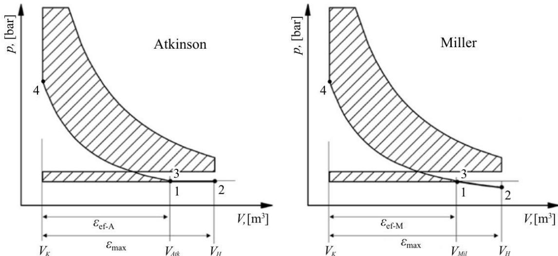
Slika 12. *pV dijagrami Atkinsonovog odnosno Millerovog procesa u Diesel motoru [13]*
