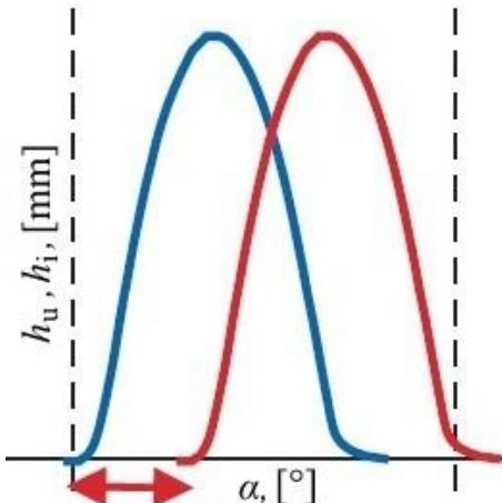
Slika 3. Primjer faznog pomicanja otvaranja ventila [1]
