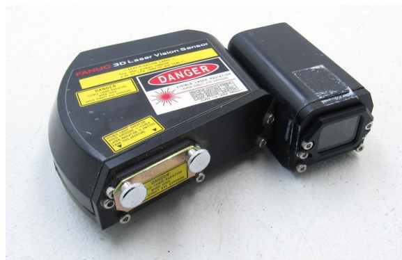
Slika 4. FANUC V-500iA senzor s kamerom
