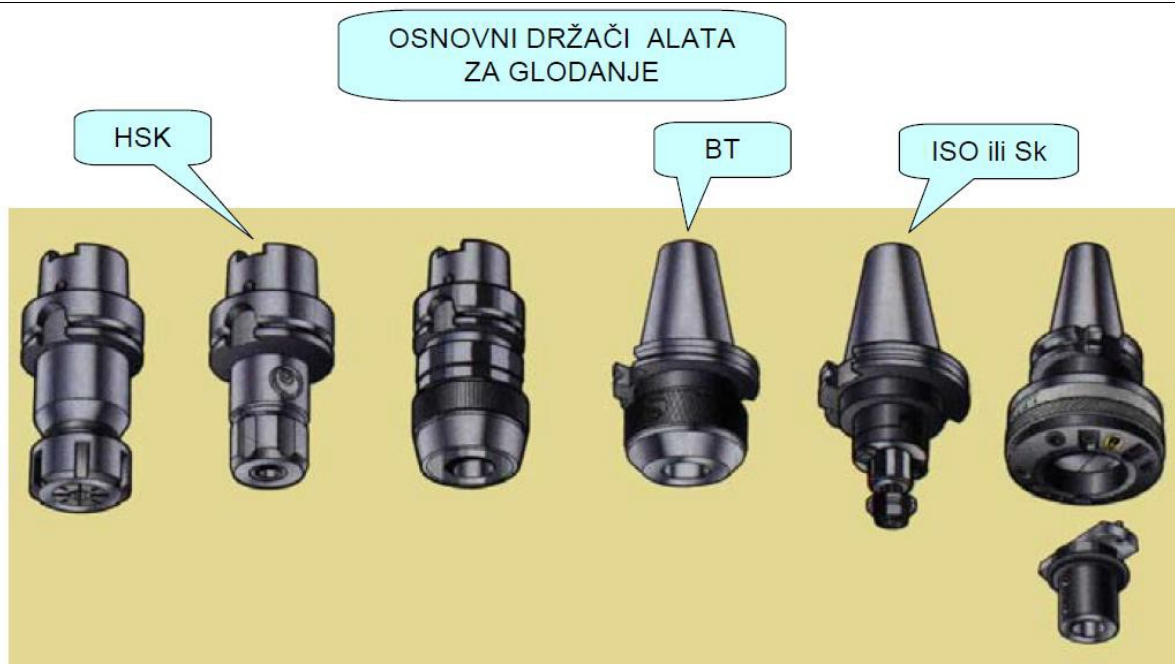
Slika 30. Osnovne vrste držača alata za glodanje [22]
