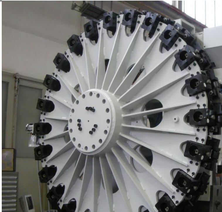
Slika 23. Kružni magazin alata [17]
