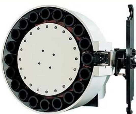
**Slika 24. Kružni magazin s manipulatorom[14]**
