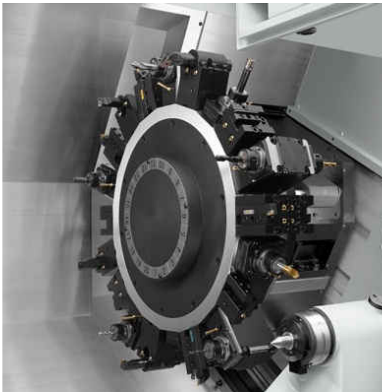
Slika 21. Revolverska galava s 20 alata [13]
