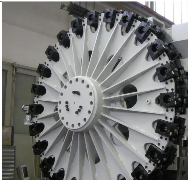
**Slika 23. Kružni magazin alata [17]**
