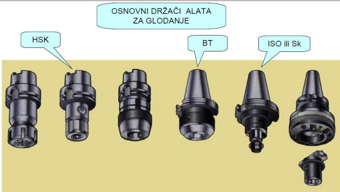
Slika 30. Osnovne vrste držača alata za glodanje [22]
