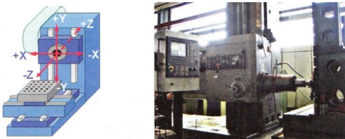
Slika 8. Horizontalna glodalica [6]
