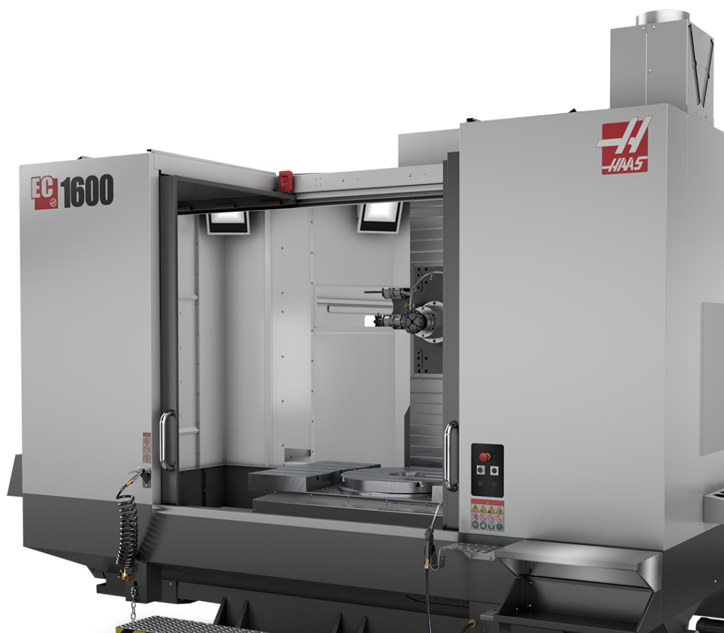
Slika 11. Horizontalni GOC - HAAS EC-1600 [10]
