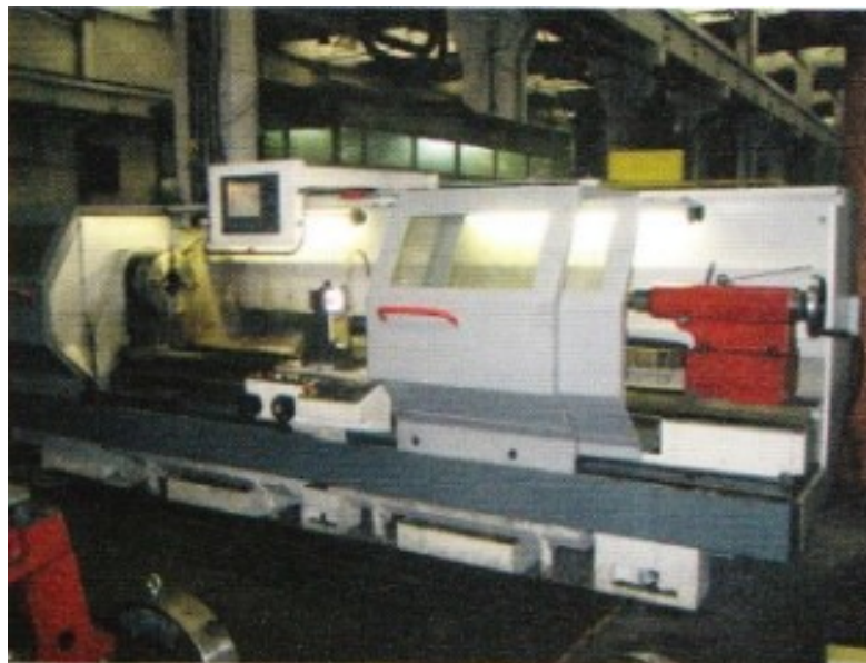
Slika 9 Horizontalna CNC tokarilica [6]
