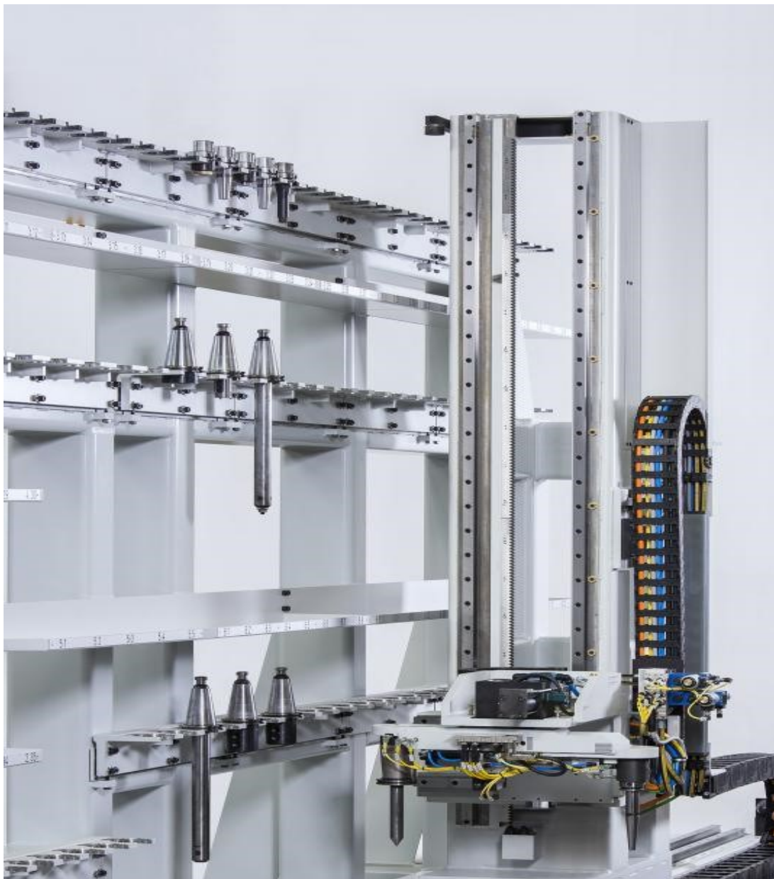
Slika 27. Regalno skladište alata [19]
