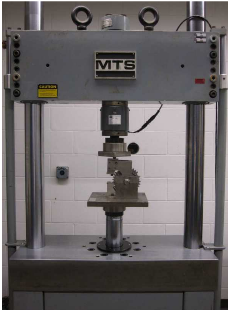
Slika 14: Postolje sa zupčanicom postavljeno u dinamičku kidalicu [13]
