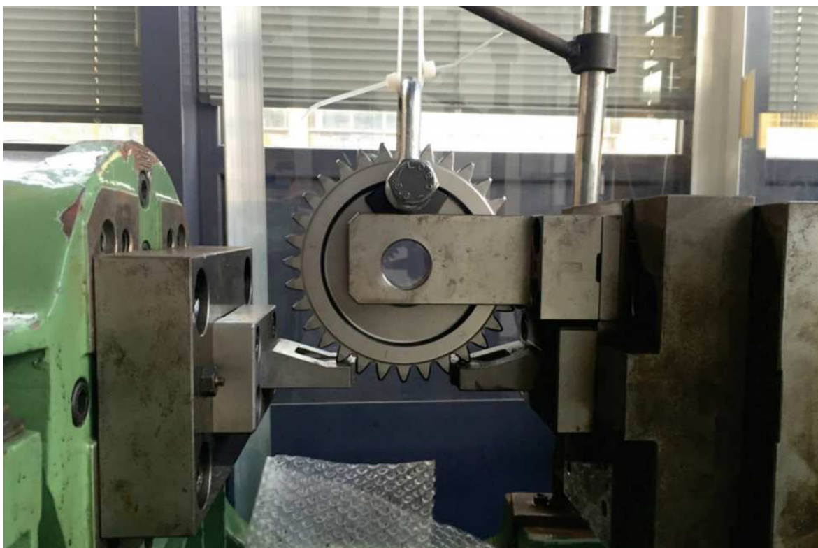
Slika 9: Istovremeno opterećivanje dva zuba [18]
