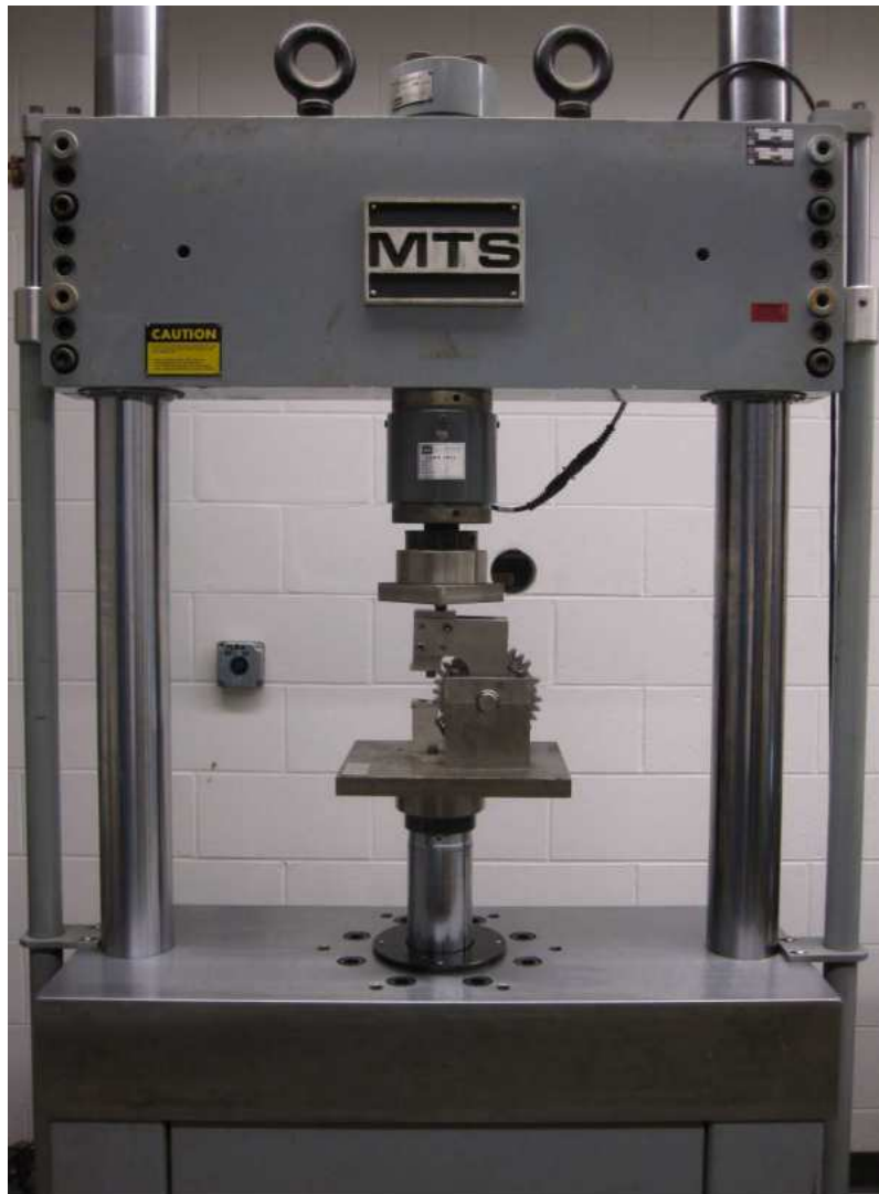
Slika 14: Postolje sa zupčanicom postavljeno u dinamičku kidalicu [13]
