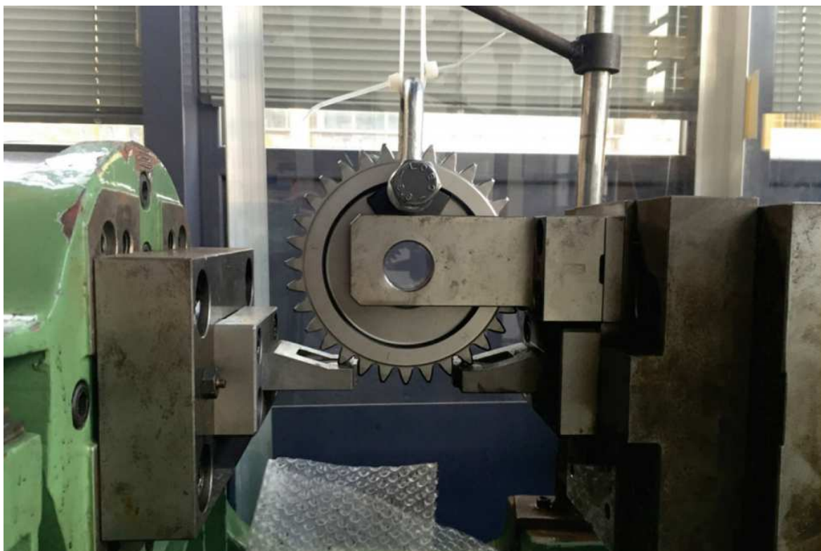
Slika 9: Istovremeno opterećivanje dva zuba [18]
