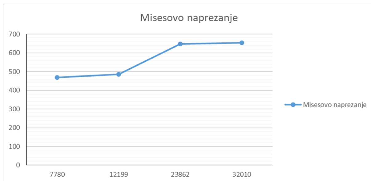
Slika 55. Konvergencija rješenja – Von Misesovo naprezanje
