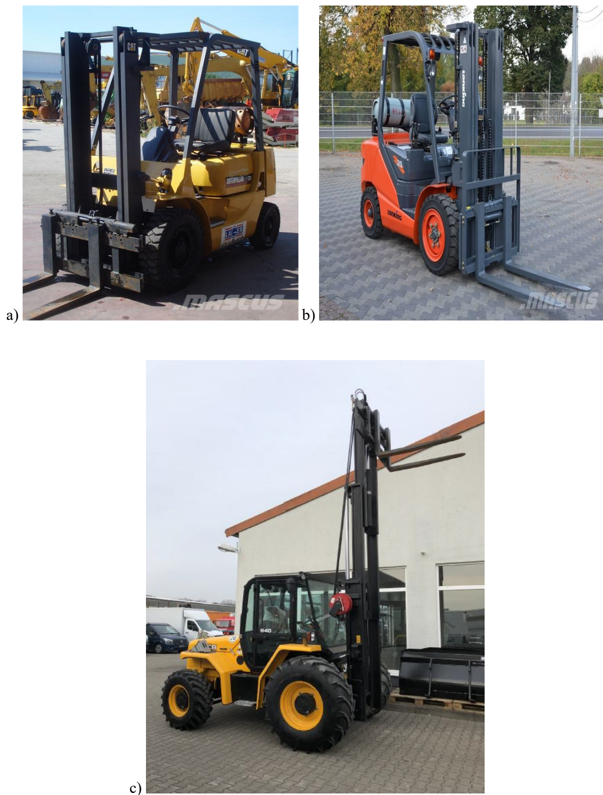
Slika 2. Čelni viličar: a) Simpleks [3], b) Dupleks [4], c) Tripleks [5]
