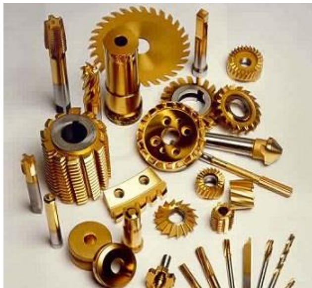
Slika 7. Rezni alati prevučeni TiN prevlakom [13]
