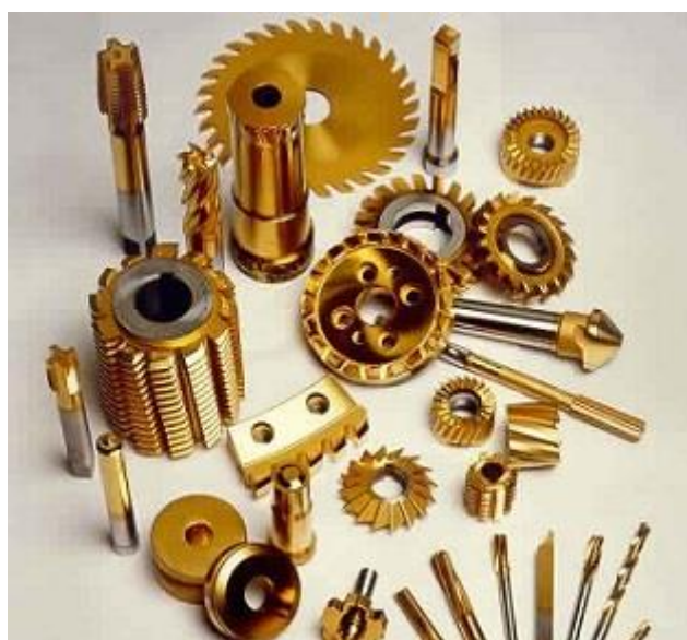
Slika 7. Rezni alati prevučeni TiN prevlakom [13]
