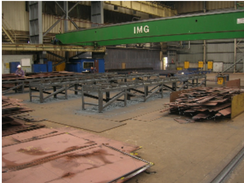
Slika 8. Stolovi za ručno skošavanje rubova – pripremu za zavarivanje
