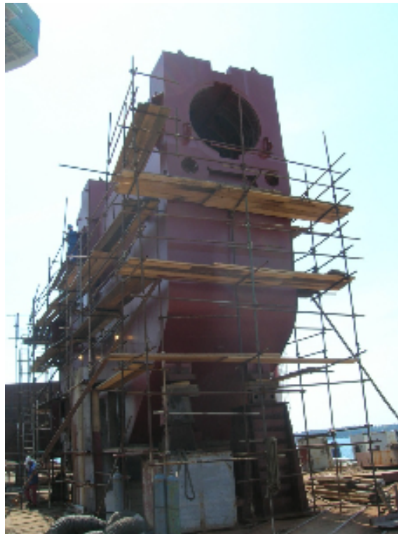
Slika 53. Sekcija nosača pilona broda jaružara
