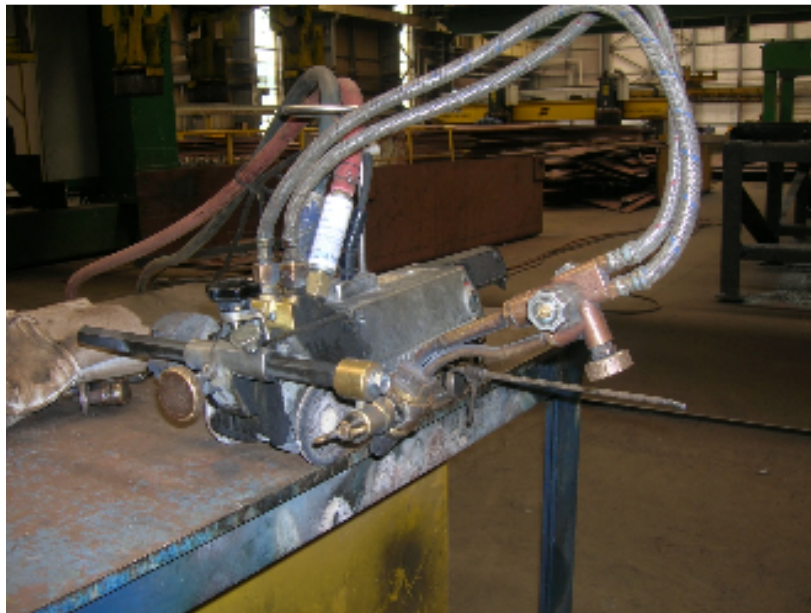
Slika 9. Poluautomatski strojevi za skošavanje rubova
