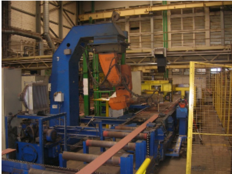
Slika 27. Robot za rezanje isključivo acetilen-kisikom
