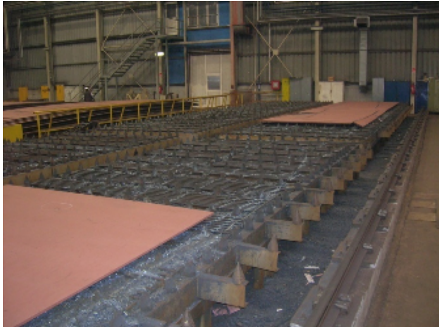
Slika 20. Stol za rezanje acetilen kisikom
