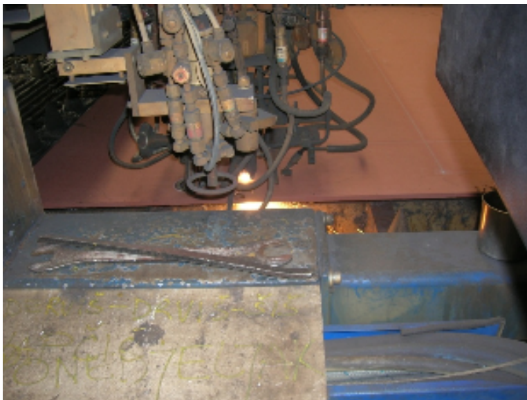
Slika 22. Glava OXY stroja ispred koje je vidljiv magnet pomoću kojeg se određuje udaljenost plamena od lima
