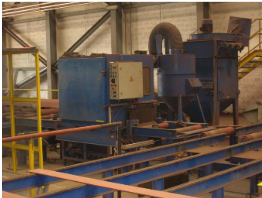
Slika 11. Stroj za sačmarenje profila
