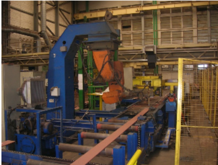
Slika 27. Robot za rezanje isključivo acetilen-kisikom
