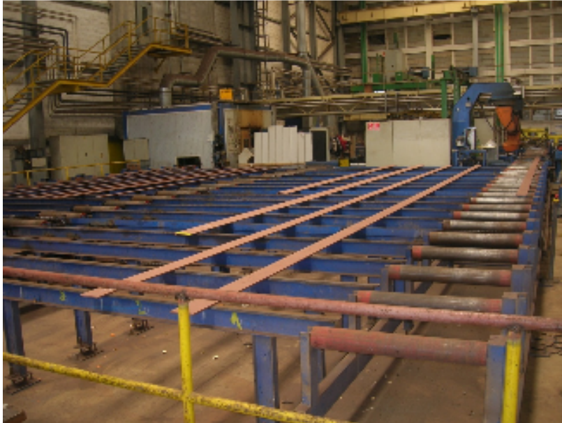
Slika12. Robot linija za obradu profila
