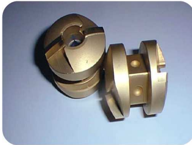
Slika 12. PACVD prevučeni alat za rezanje [29]
