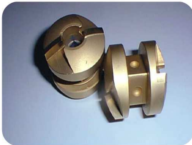
Slika 12. PACVD prevučeni alat za rezanje [29]
