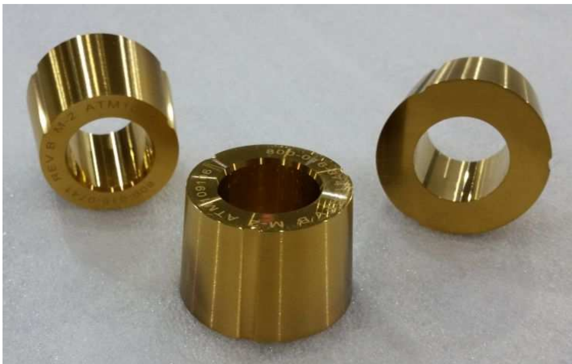
Slika 8. PVD prevučeni ekstruzijski kalup [18]
