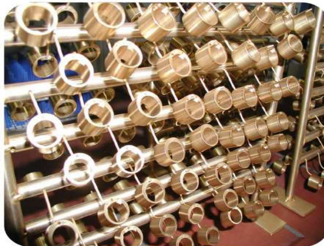
Slika 13. Prevučeni konstrukcijski dijelovi [29]
