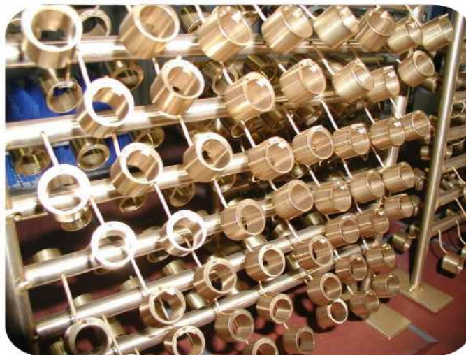
Slika 13. Prevučeni konstrukcijski dijelovi [29]
