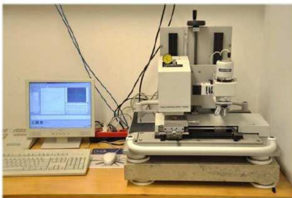
Slika 39. Tvrdomjer Vickers Helmut Fisher Fischerscope H100C za mjerenje tvrdoće prevlaka
