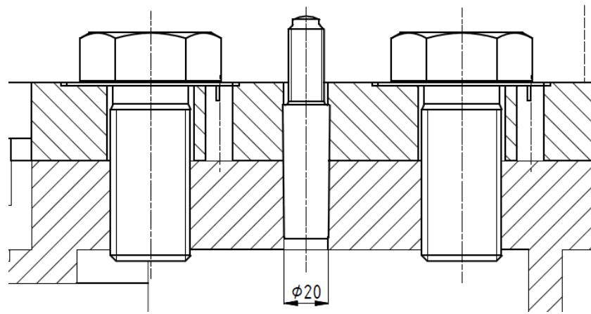
**Slika 17.** Zatik u spoju između nosača i kućišta
