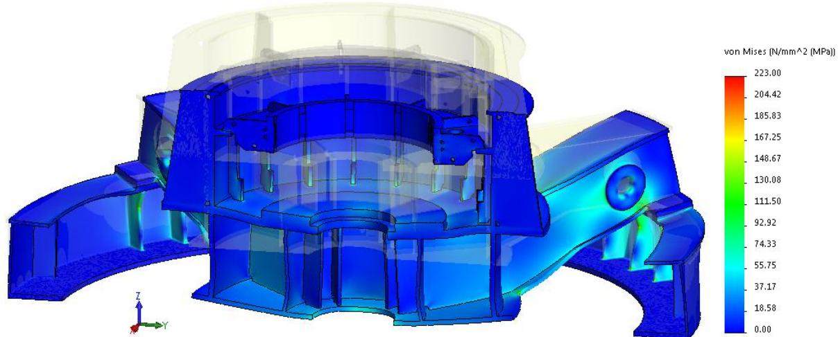
Slika 35. Naprezanje po von Mises-u s granicom do 2/3 R<sub>p0.2</sub> za 3. uvjet rada
