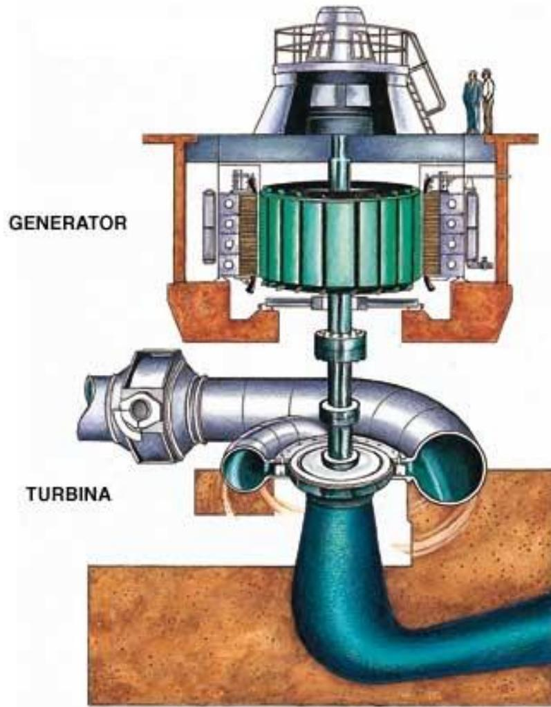
Slika 3. Vertikalni položaj hidrogeneratora [4]
