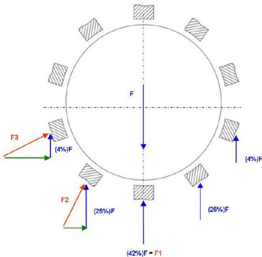
**Slika 19. Raspored radikalne sile na segmente[5]**
