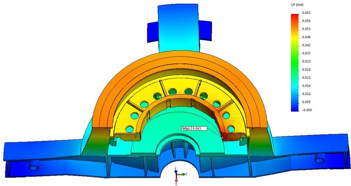
**Slika 39.** Pomak nosača po Y osi na mjestu vodećeg ležaja uslijed djelovanja radijalne sile u ruku nosača pri nominalno brzini
