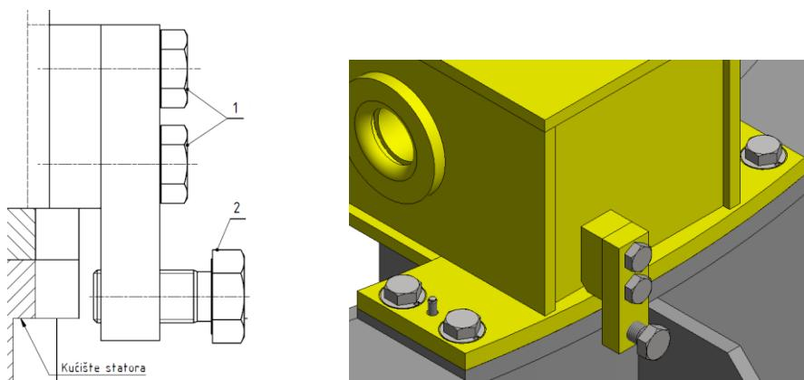
**Slika 10. Vijak za centriranje nosača na kućište statora**
