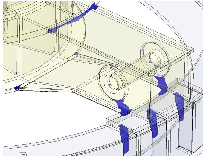
Slika 32. Unutarnja koncentracije naprezanja
