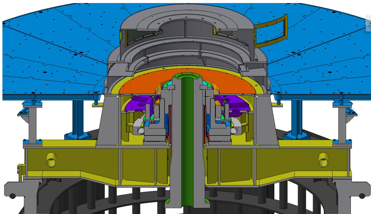
**Slika 41.** Presjek sklopa nosača s ostalim dijelovima
