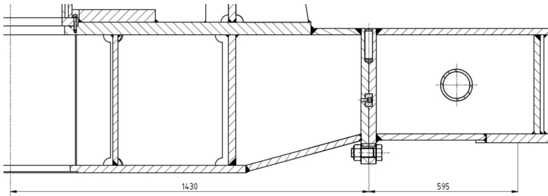
**Slika 12. Položaj vijčanog spoja ruke na nosaču**
