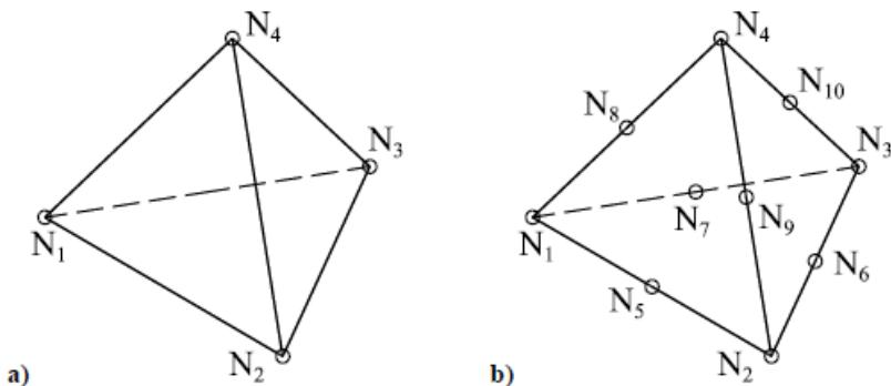
Slika 20. Tetraderski konačni element: a) osnovni, b) parabolični [17]
