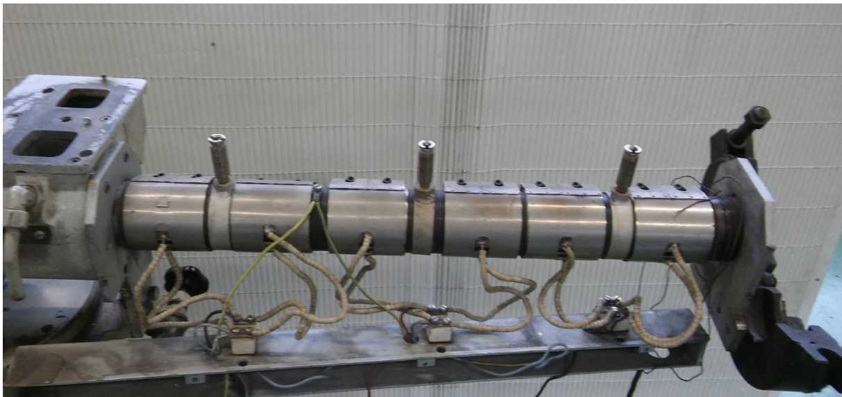
Slika 39. - Prstenasti grijači podijeljeni u tri toplinske zone
