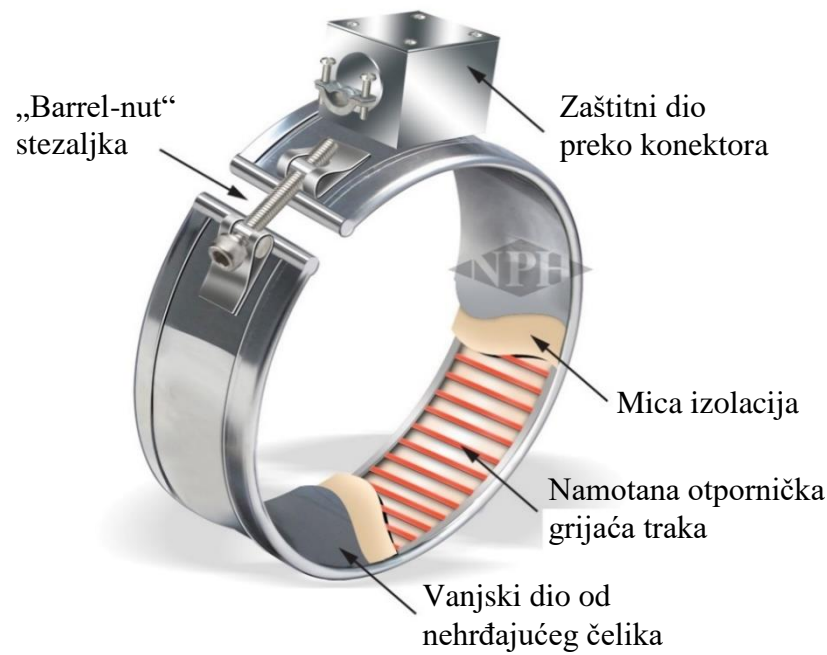
Slika 32. - Prstenasti grijač izoliran „mica“ materijalom[7]
