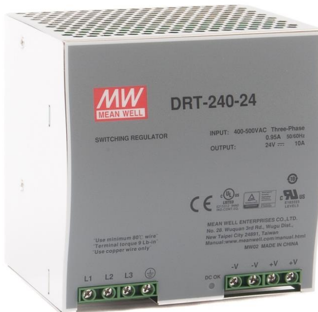
Slika 46. - Izvor napajanja Mean Well DRT-240-24 [12]
