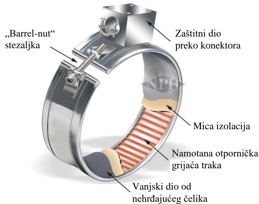
Slika 32. - Prstenasti grijač izoliran „mica“ materijalom[7]
