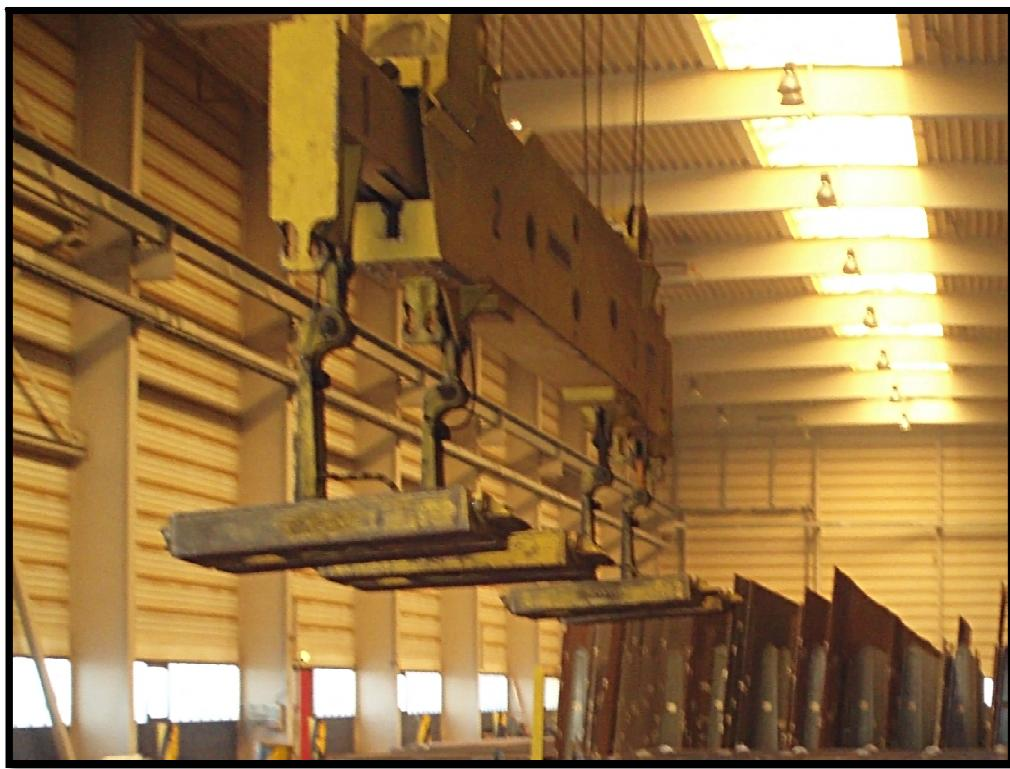
Slika 25. – Primjer grede sa magnetima za naginjanje limova
