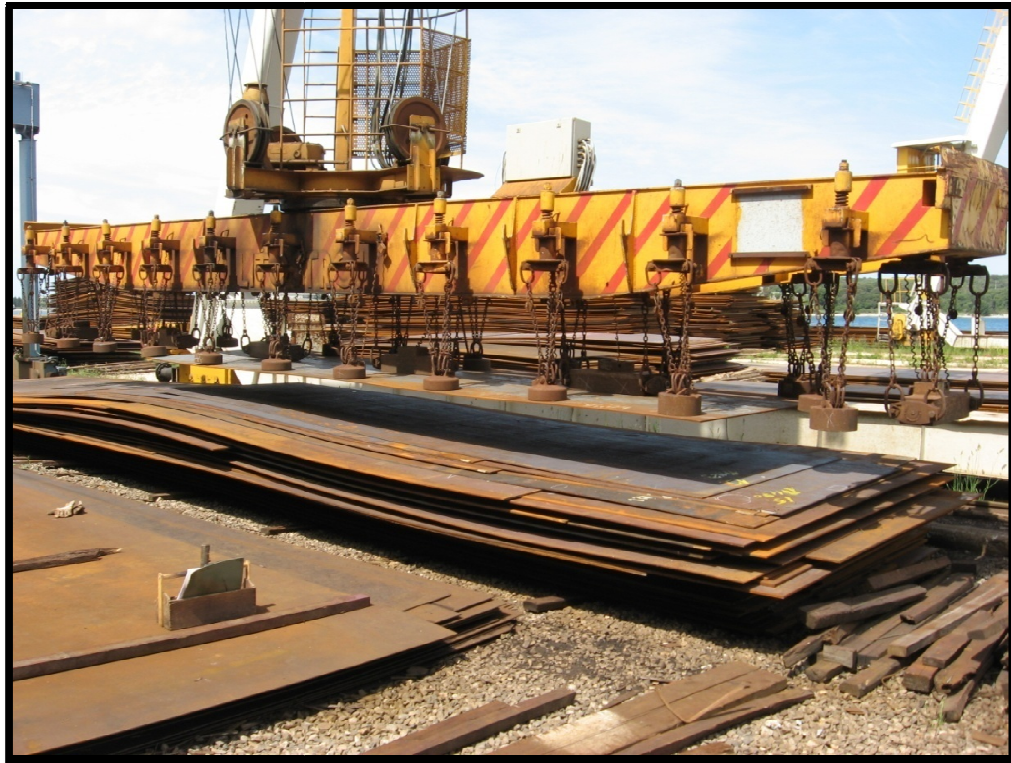
Slika 5. – Roštilj sa magnetima na magnetnoj dizalici
