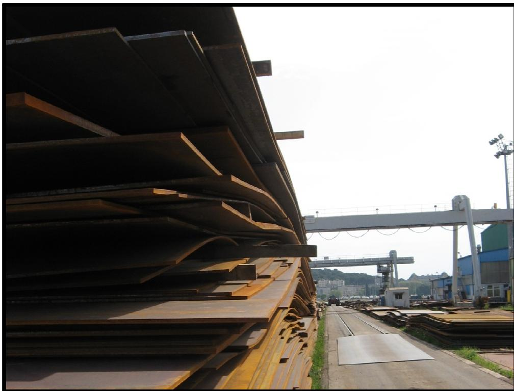
Slika 13. – Iskrivljeni limovi uslijed neadekvatnog skladištenja
