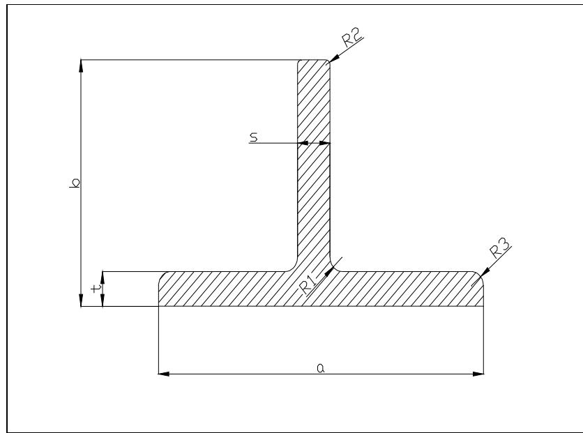
Slika 3. – Poprečni presjek valjanog T-profila
