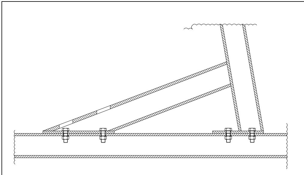
Slika 18. – Detalj vijčanog spoja nosača limova
