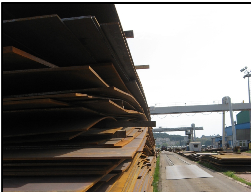
Slika 13. – Iskrivljeni limovi uslijed neadekvatnog skladištenja
