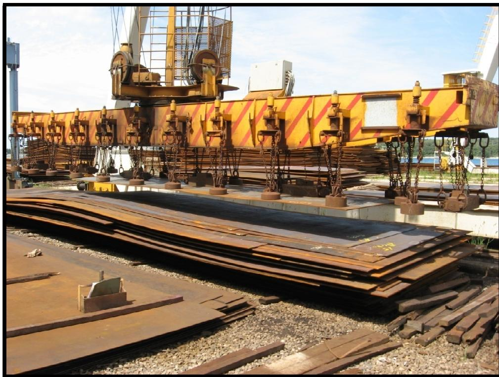
Slika 5. – Roštilj sa magnetima na magnetnoj dizalici
