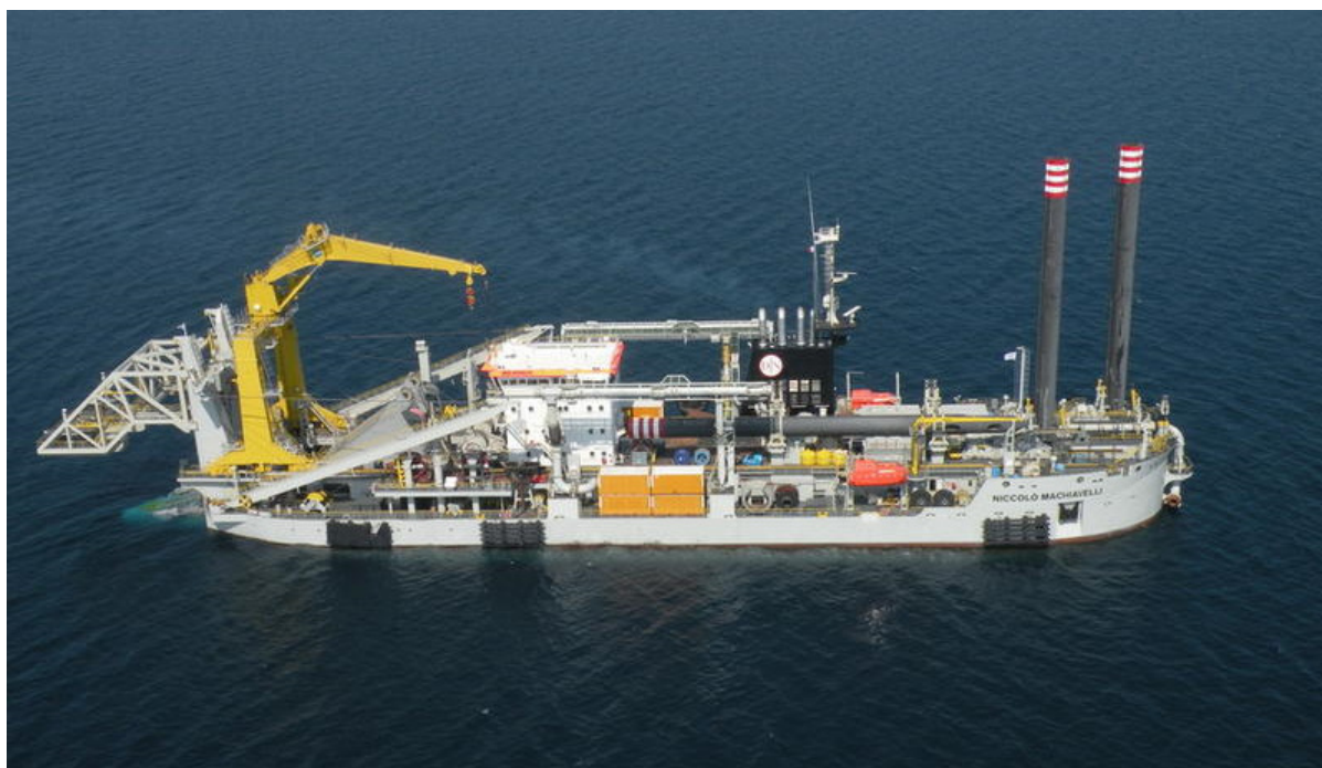
Slika 21. Jaružalo na vlastiti pogon u plovidbi
