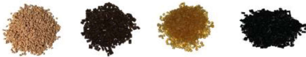
Slika 27. Poliamidno punilo u formi granulata [11]
