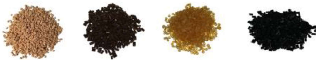
Slika 27. Poliamidno punilo u formi granulata [11]
