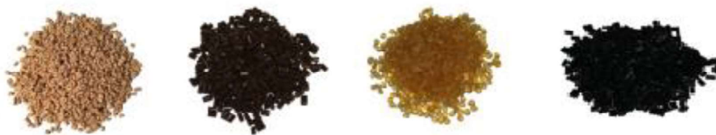
Slika 27. Poliamidno punilo u formi granulata [11]
