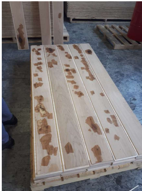
Slika 6. Parket složen na paletu nakon nanošenja punila
