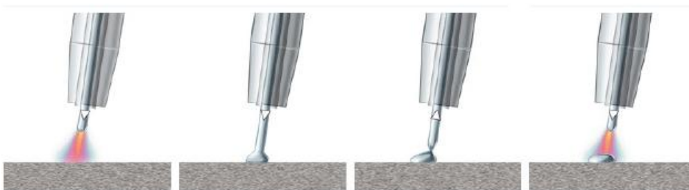
Slika 15. CMT postupak zavarivanja [25]
