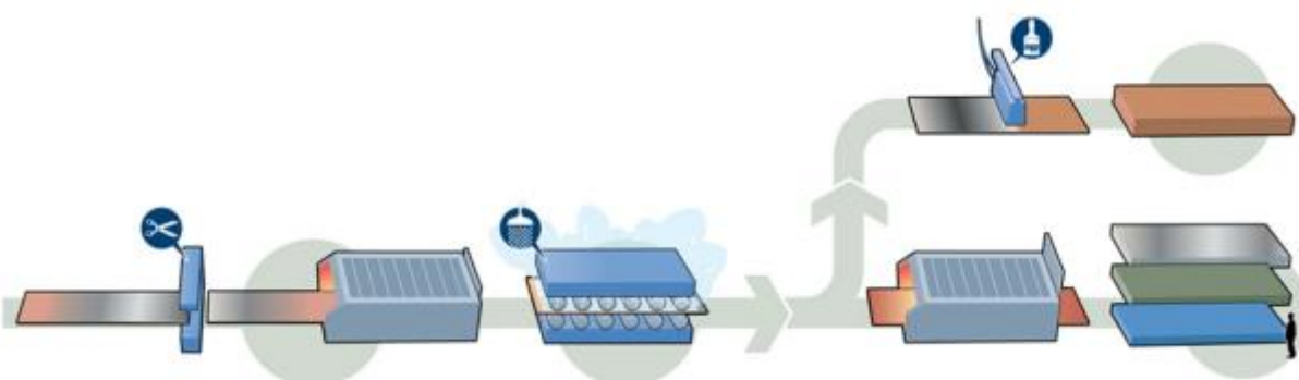
Slika 6. Rezanje, popuštanje, gašenje, pjeskarenje i površinska zaštita premazom [2]
