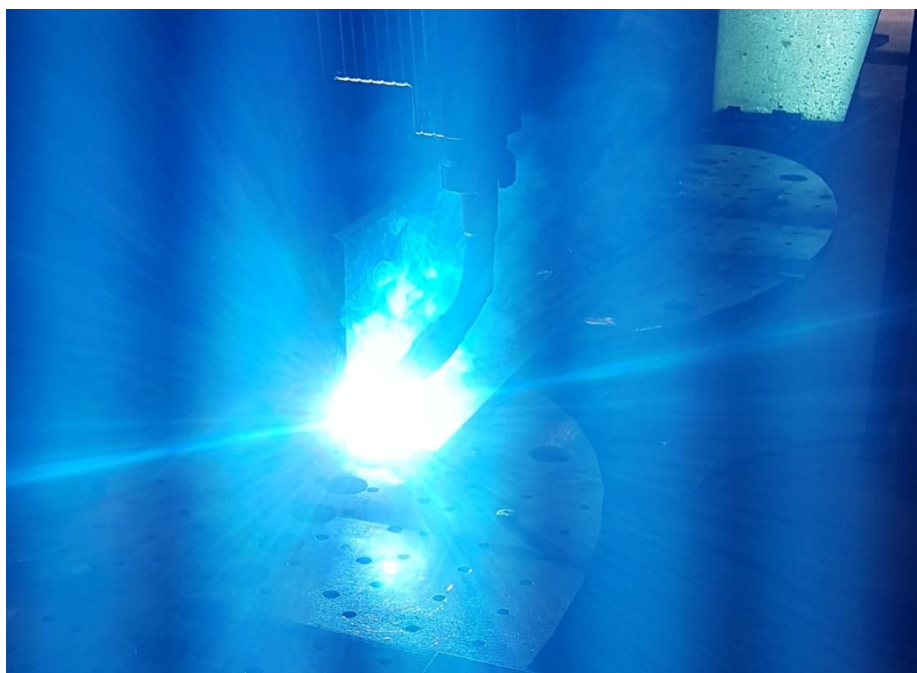
Slika 23. Zavarivanje kutnog uzorka
