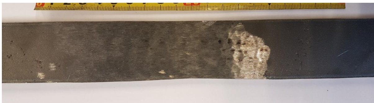
Slika 31. Epruveta za ispitivanje savijanjem
