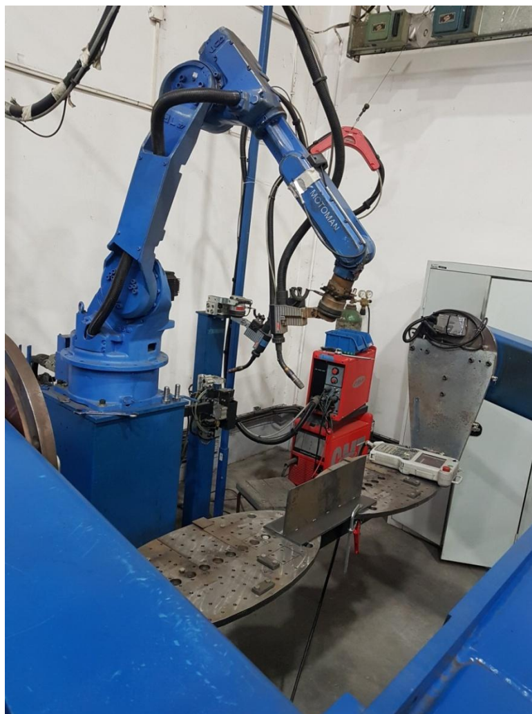
Slika 17. Robotska ruka, pozicioner i izvor struje za zavarivanje
