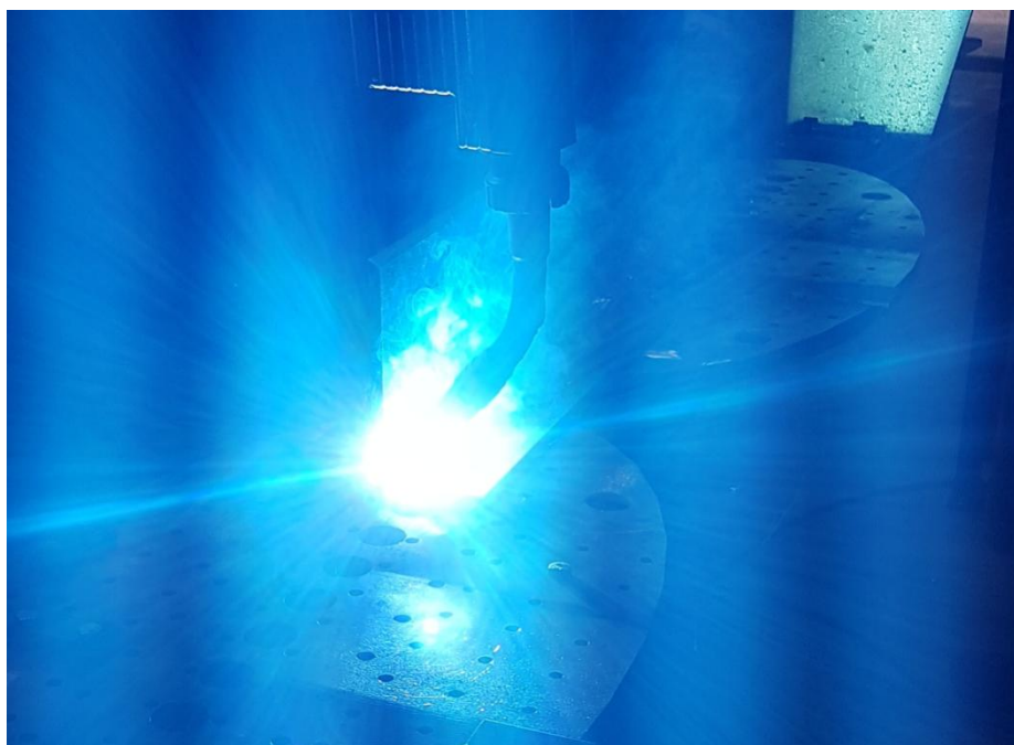
Slika 23. Zavarivanje kutnog uzorka
