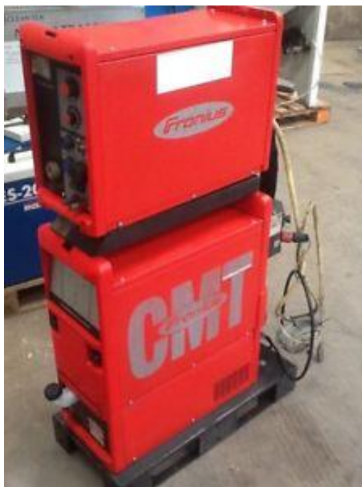
Slika 18. Izvor struje za zavarivanje Synergic 4000 CMT R
