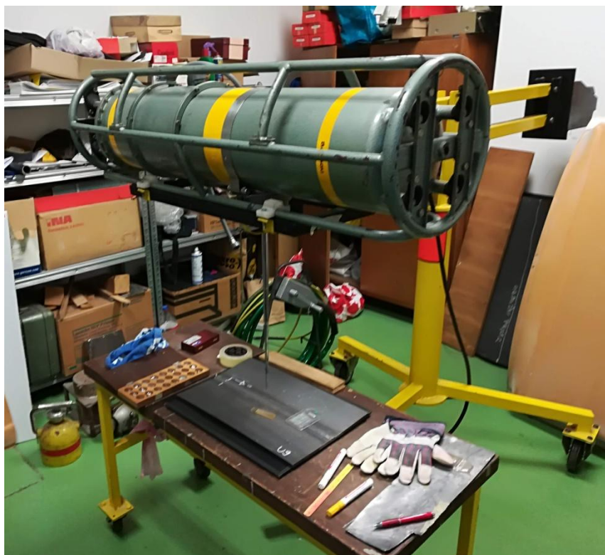
Slika 27. Rendgen uređaj BALTEAU GM 300D
