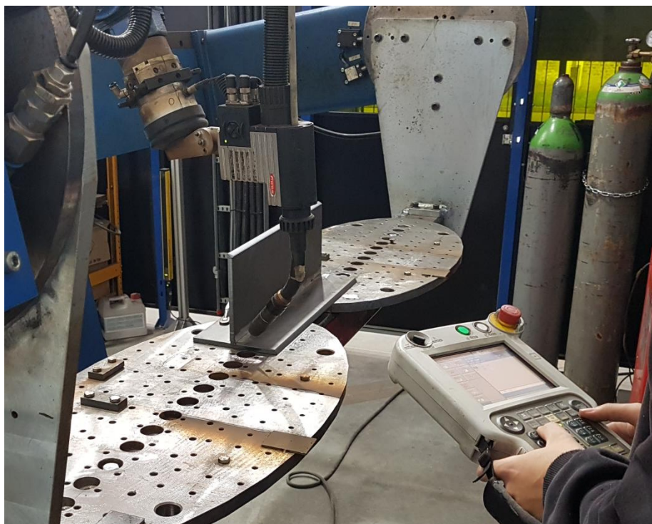
Slika 22. Programiranje robota za zavarivanje
