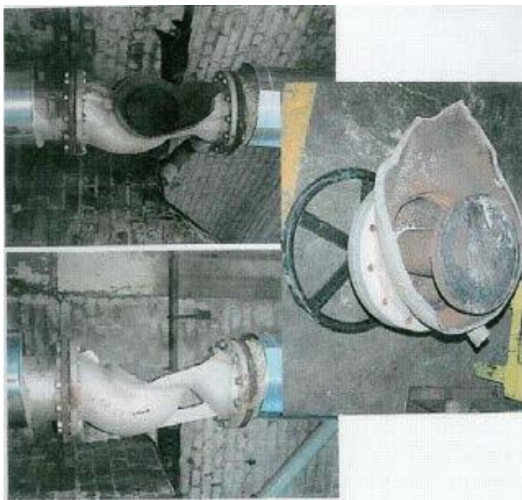
Slika 9. Puknuće cijevi zbog hidrauličkog udara [8]
