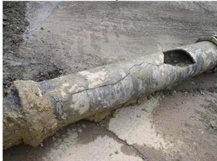
Slika 9. Puknuće cijevi zbog hidrauličkog udara [8]
