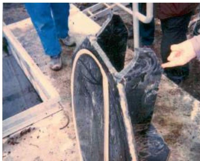
**Slika 8. Oštećenje nepovratnog ventila zbog hidrauličkog udara [3]**
