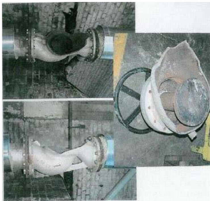
Slika 9. Puknuće cijevi zbog hidrauličkog udara [8]
