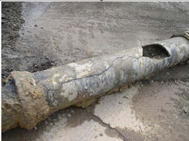
Slika 9. Puknuće cijevi zbog hidrauličkog udara [8]
