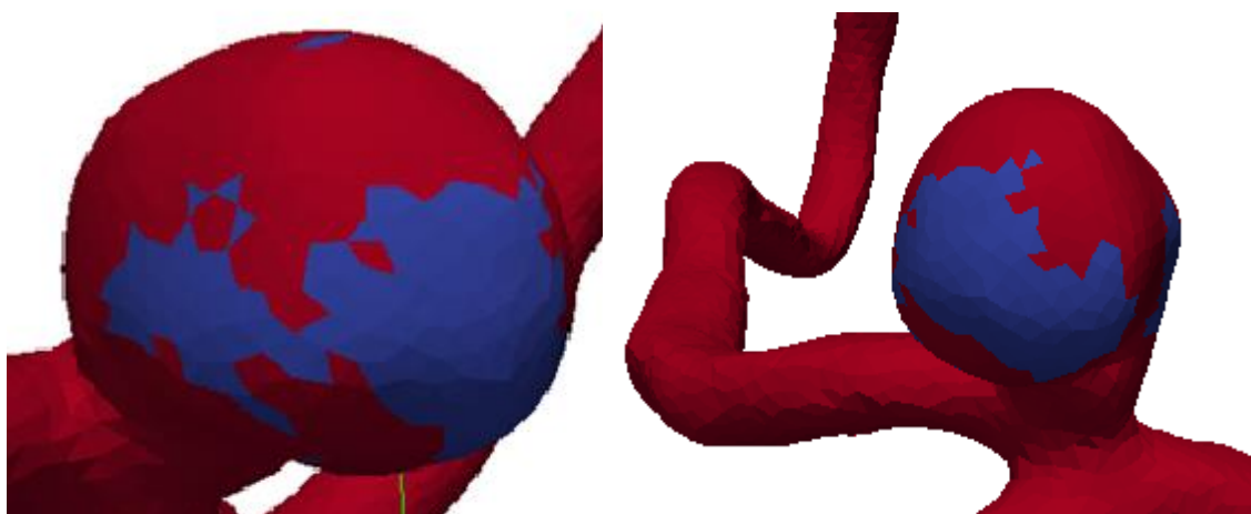
Slika 50. Smično naprezanje > 0,4 \text{ [g/mm}\cdot\text{s}^2] na aneurizmi
