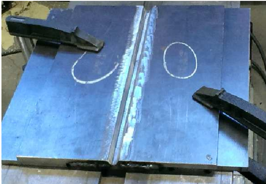
Slika 22: Pozicioniranje ploča za zavarivanje na podlozi
