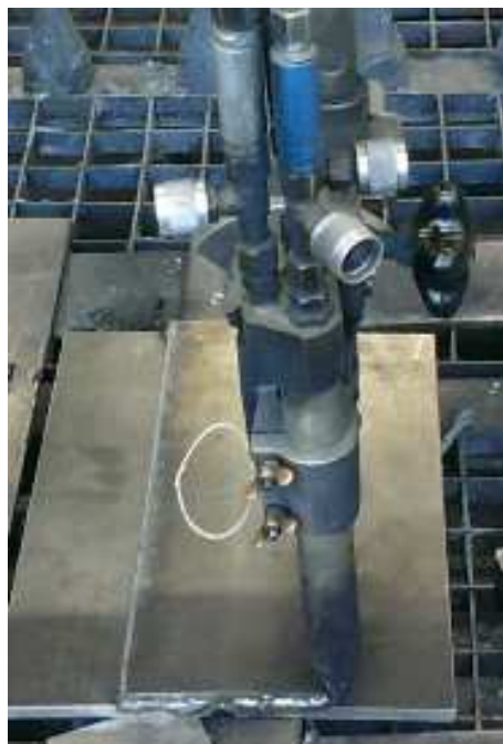
Slika 27: Reduciranje širine zavarenih ploča na plinskoj rezačici
