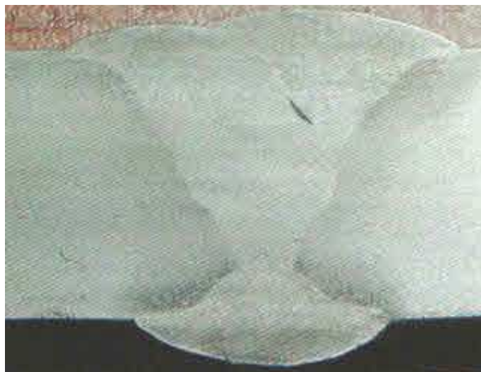
Slika 11: Naljepljivanje između slojeva zavara [10]
