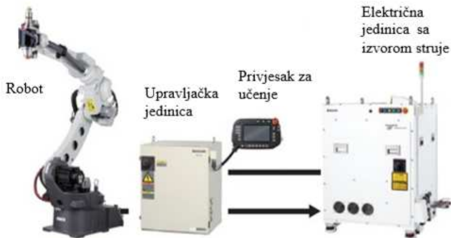
Slika 15: Glavne komponente robotske stanice za zavarivanje [26]
