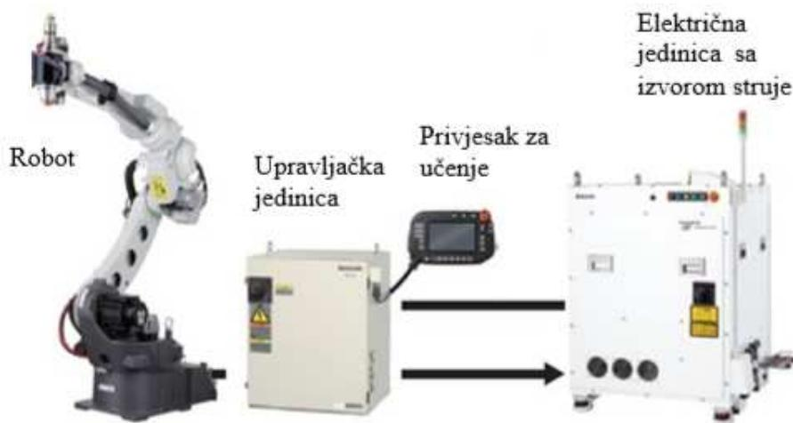
Slika 15: Glavne komponente robotske stanice za zavarivanje [26]
