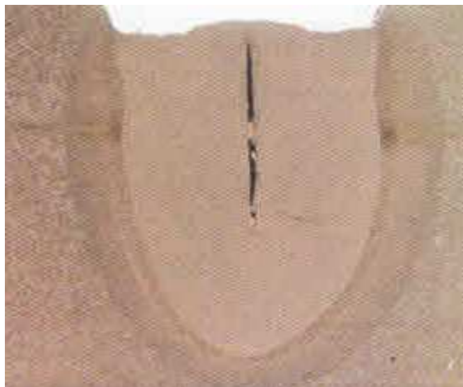
Slika 13: Topla pukotina u metalu zavara [10]
