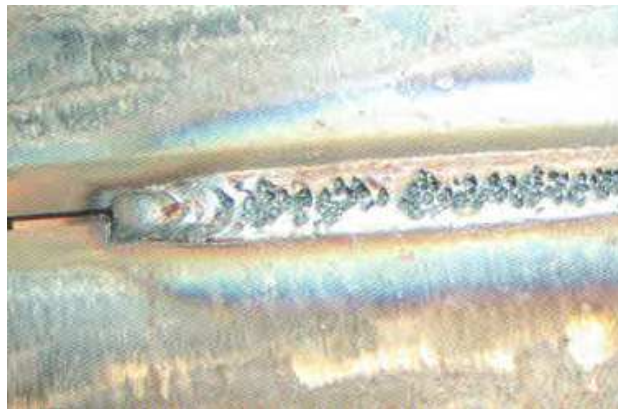
Slika 10: Pore u korijenu kod MAG zavarivanja čelika [10]
