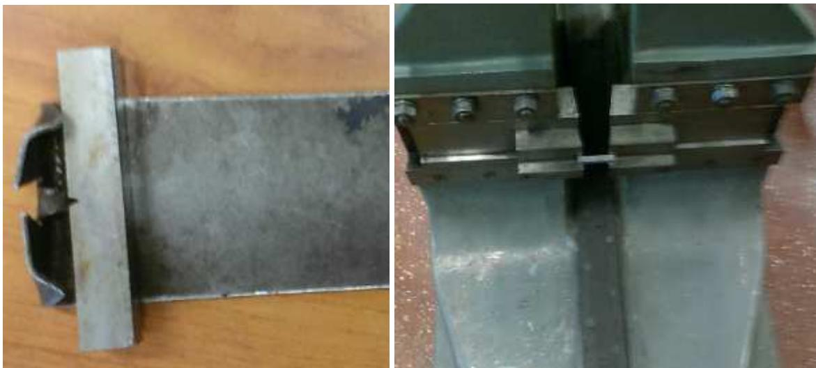
Slika 36: Namještanje ispitnog uzorka na nakovanj uređaja
