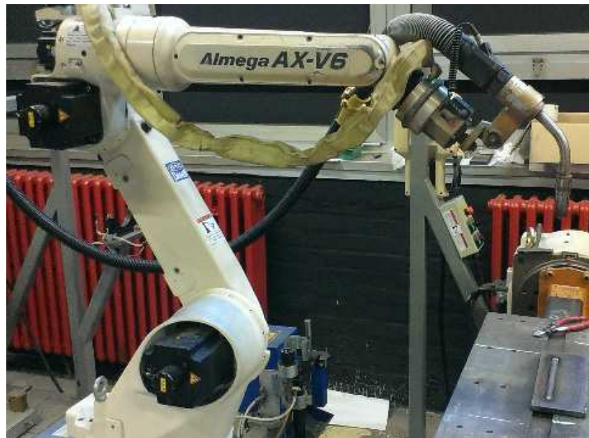
Slika 19: Robotska jedinica Almega AX – V6
