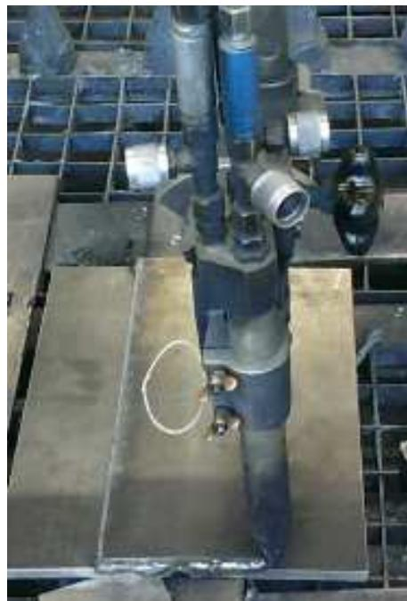
Slika 27: Reduciranje širine zavarenih ploča na plinskoj rezačici
