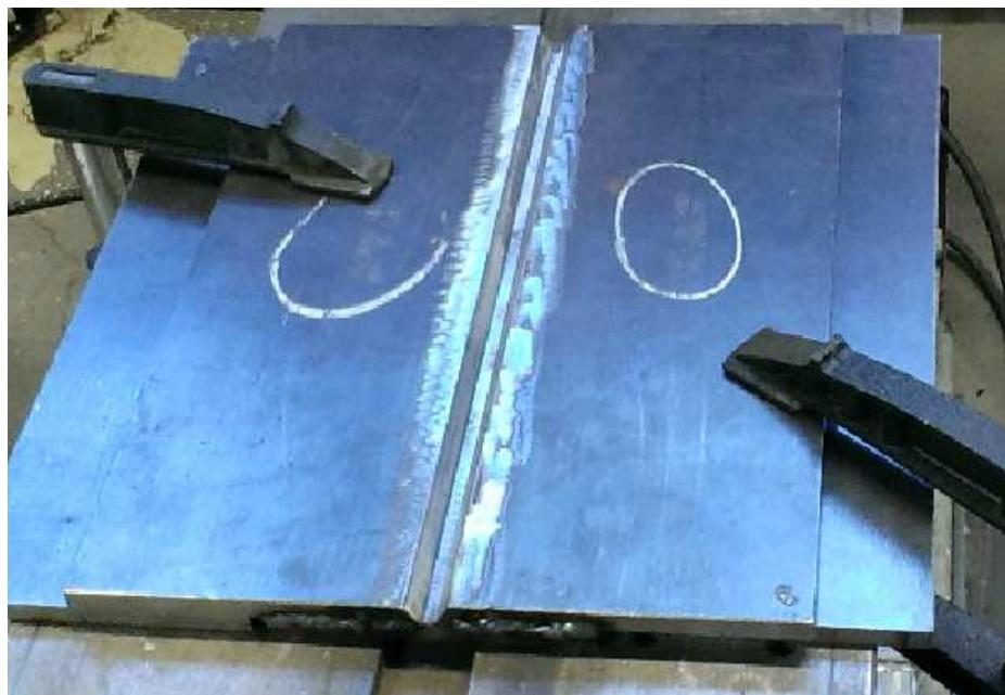
Slika 22: Pozicioniranje ploča za zavarivanje na podlozi
