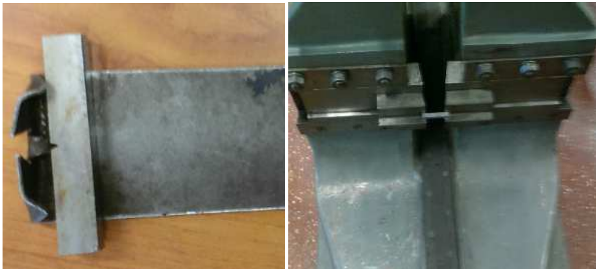
Slika 36: Namještanje ispitnog uzorka na nakovanj uređaja
