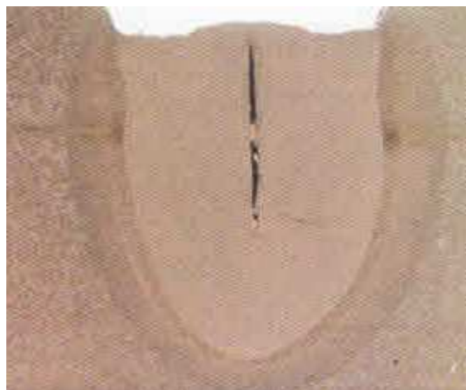
Slika 13: Topla pukotina u metalu zavara [10]
