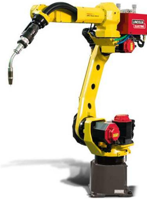
Slika 16: Robot Fanuc za elektrolučno zavarivanje [28]
