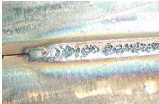
Slika 10: Pore u korijenu kod MAG zavarivanja čelika [10]
