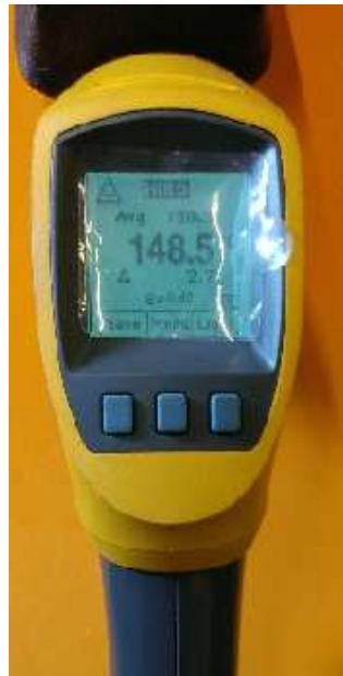
Slika 25: Bezkontaktni IR termometar
