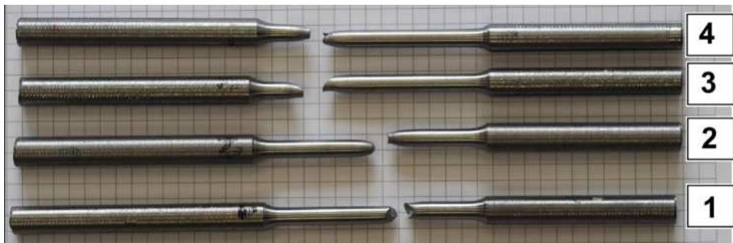
Slika 35: Epruvete nakon provedenog ispitivanja na kidalici
