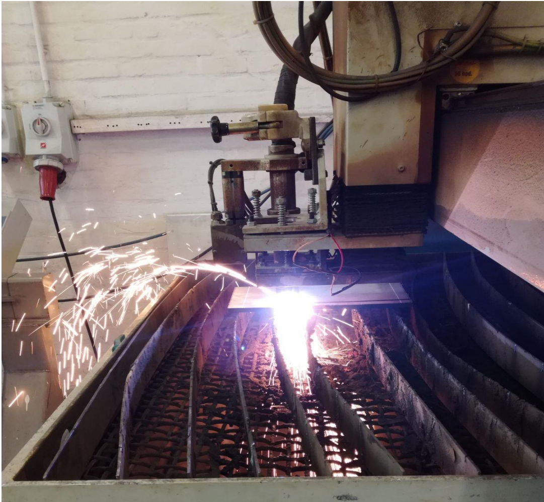
Slika 28. CNC rezanje plazmom
