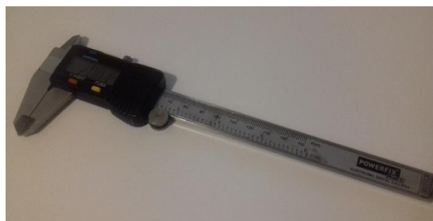
Slika 7.6: Powerfix digitalna pomična mjerka
