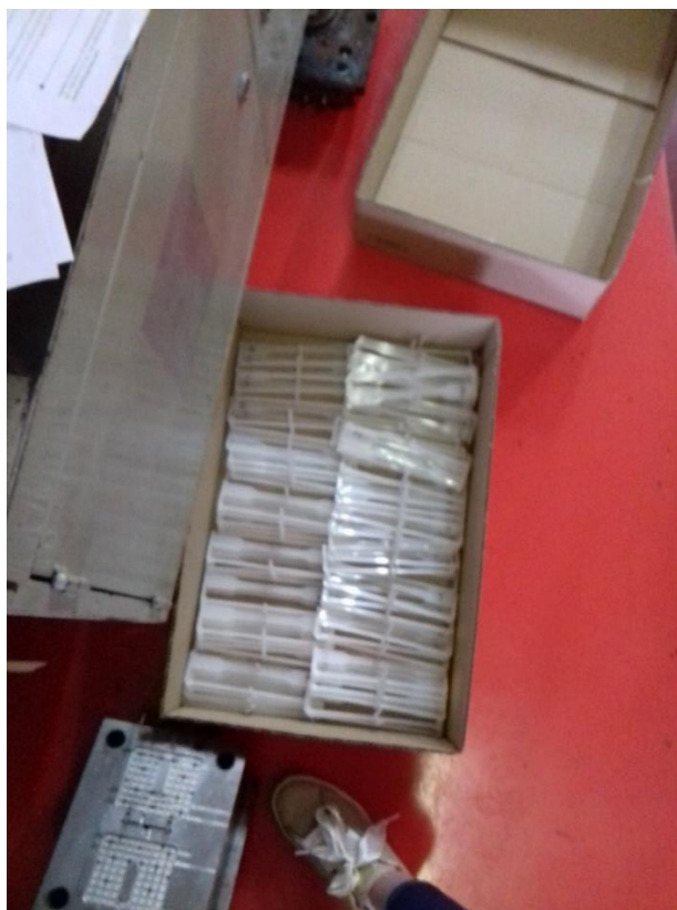
Slika 7.13: Injekcijski isprešana ispitna tijela od polipropilena
